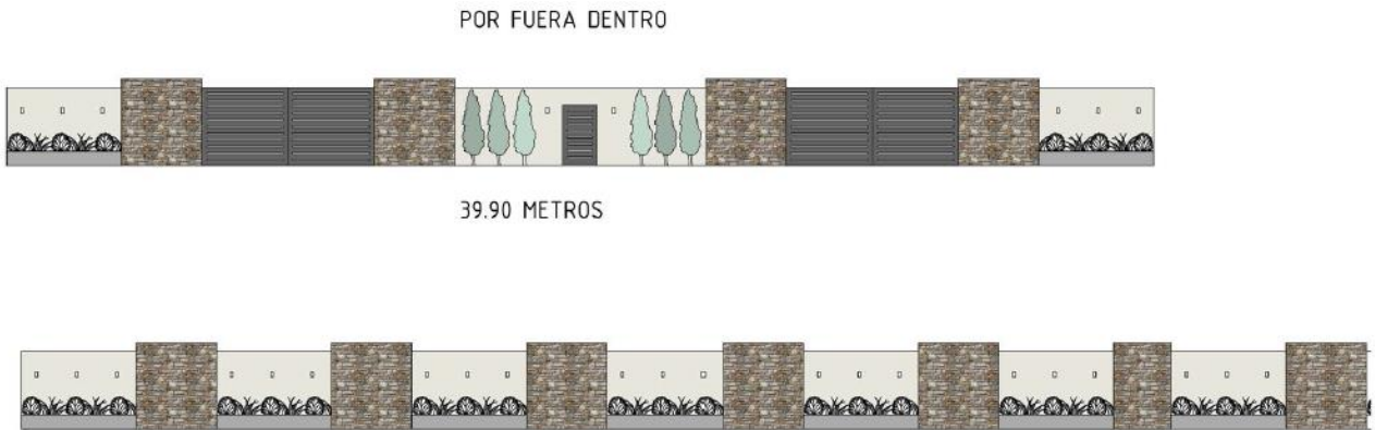
Ilustración 65. Fachadas de muro perimetral
