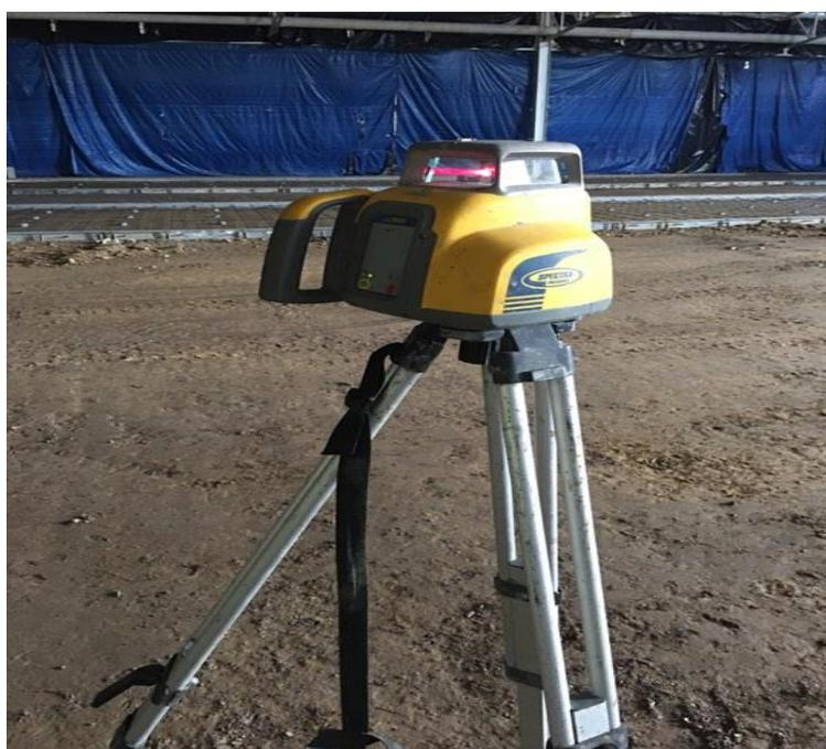
**Ilustración 16. Equipo de Nivelación.**
