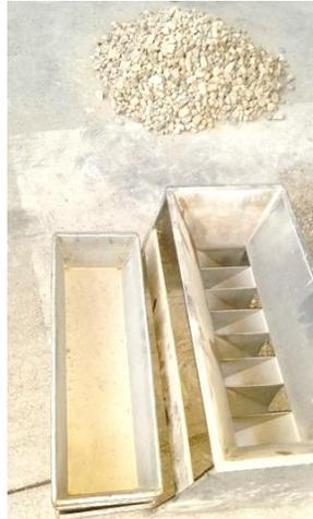
Ilustración 5. Cuarteador Mecánico para agregado grueso.
