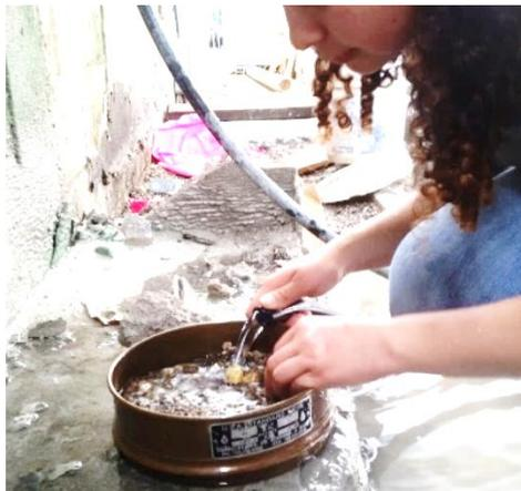
Ilustración 6. Lavar el agregado sobre un tamiz No. 200 para retener las partículas finas que contiene y hace poder tener una curva granulométrica con más información que mostrar.
