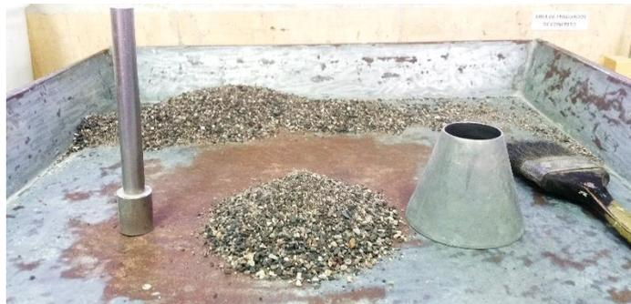
Ilustración 9. Cono de absorción de arenas y pisón de acero.
