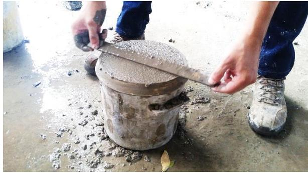
Ilustración 18. Enrazando la superficie del tazón para posteriormente pesarlo.
