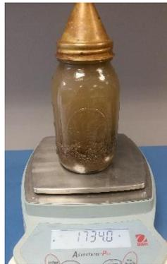
Ilustración 11. Picnómetro más agua, más arena con superficie saturada seca.
