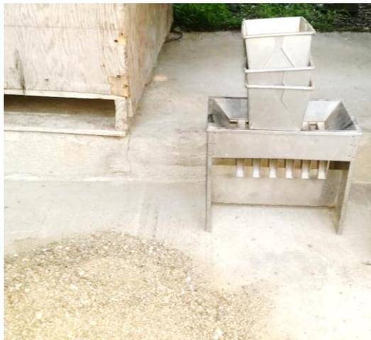
Ilustración 4. Cuarteador mecánico para agregado fino.
