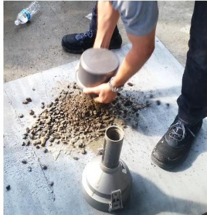
Ilustración 20. Aparato para medir el contenido de aire en el concreto fresco.
