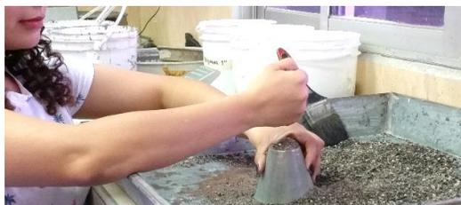
Ilustración 8. Verter la arena sobre el cono de absorción de arenas.
