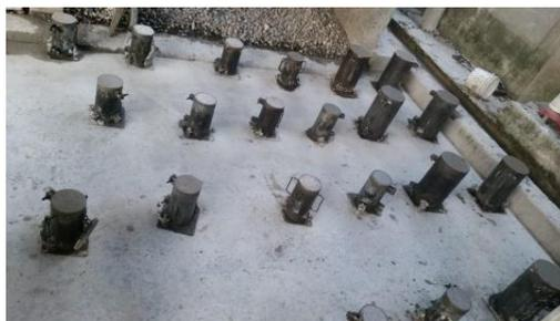
Ilustración 21. Cilindros elaborados.
