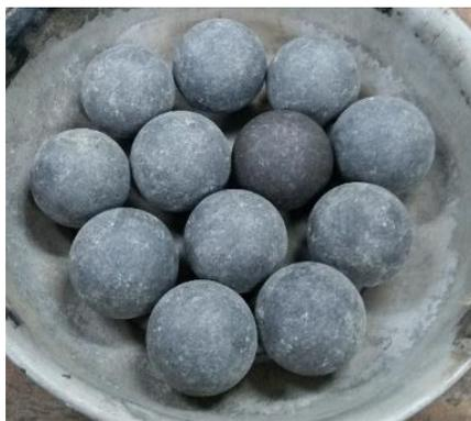
Ilustración 15. Carga abrasiva.
