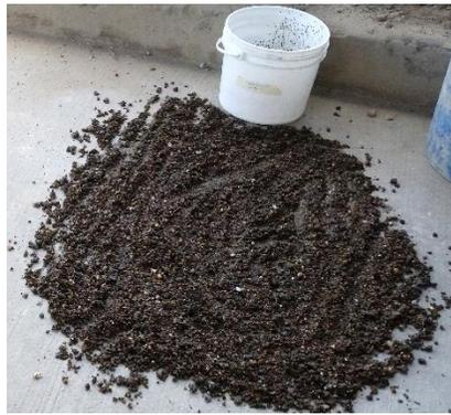
Ilustración 7. Secar la arena a temperatura ambiente.
