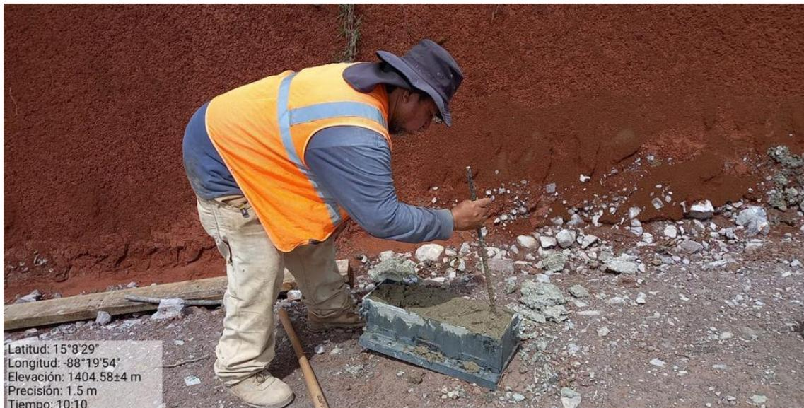
**Ilustración 31. Elaboración de viga para ensayo**
