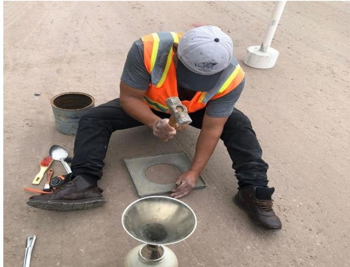
**Ilustración 5. Prueba Densidad In Situ**
