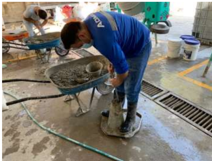
Ilustración 31 – Prueba de revenimiento para el concreto de 4000 psi
