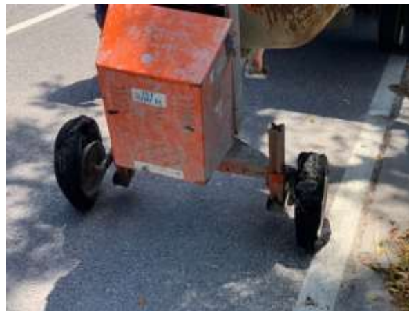
Ilustración 60 – Ruedas destrozadas debido a la fundición
