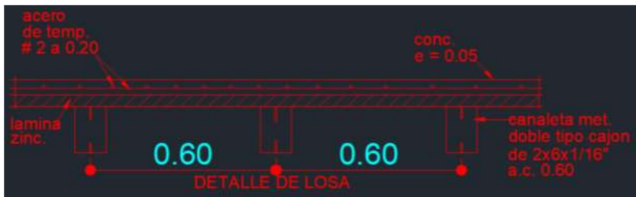
Ilustración 8 – Losa (losacero) de entrepiso, proyecto en Jaraguá
