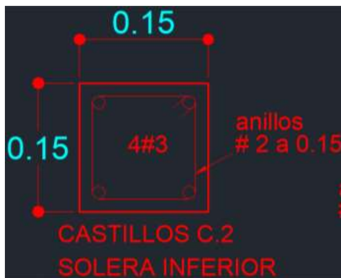
Ilustración 7 – Castillo y solera inferior, proyecto en Jaraguá
