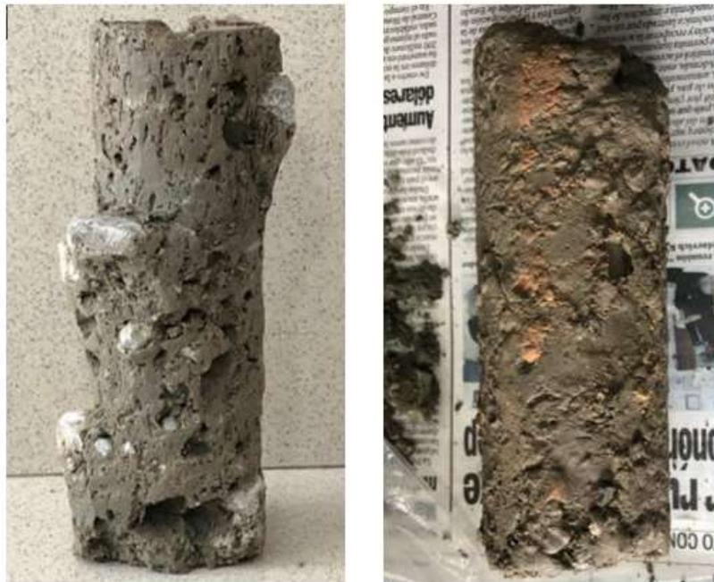
**Ilustración 13 Muestras Inalteradas para Ensayo de Triaxial
