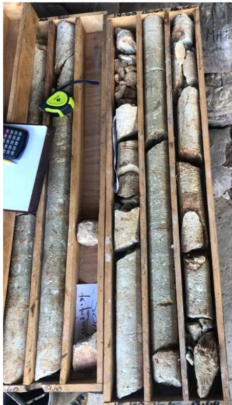
**Ilustración 6 Muestra de Rocas para Ensayo RQD**
