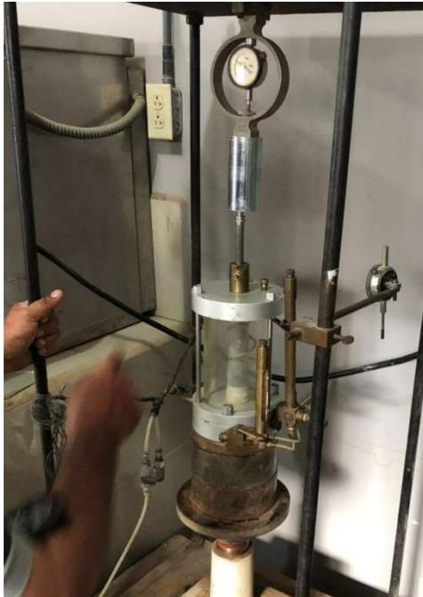
**Ilustración 15 Ensayo Triaxial No Drenada
