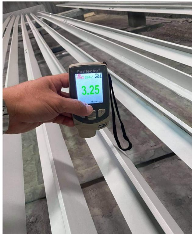
Mediciones de espesor de pintura a elementos estructurales previo a ser enviados
