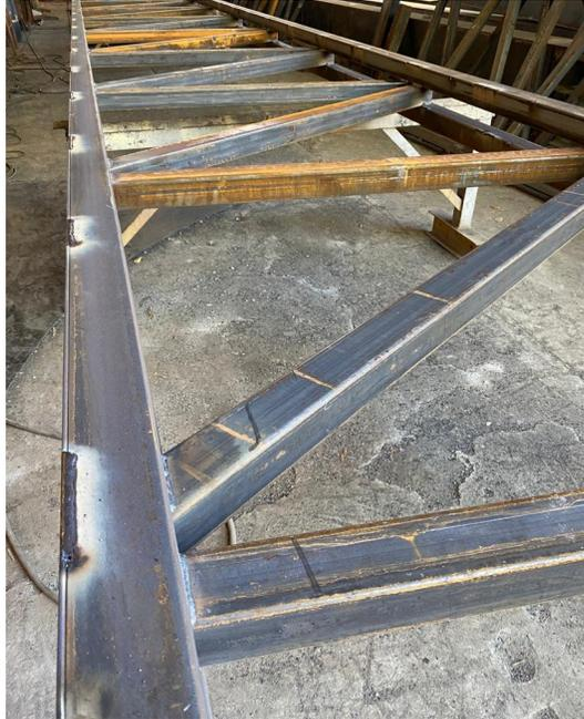
Revision de soldadura de los Joist de carga previo a ser trasladados a pintura
