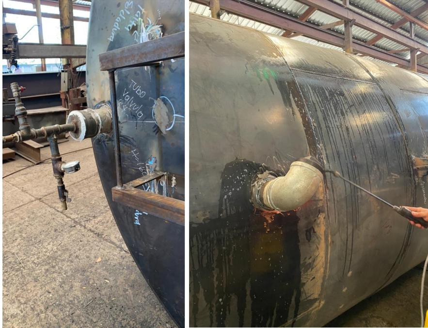
Prueba Neumática a Tanque de 3,000 galones
