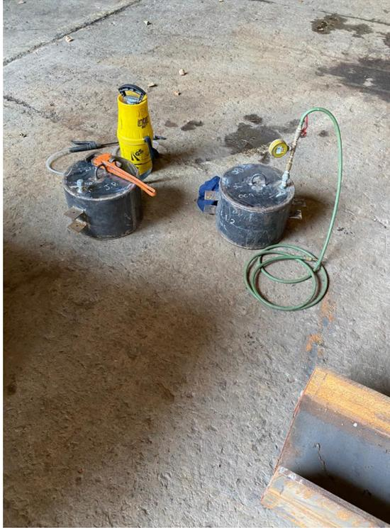
Prueba neumática a flotadores de tanque
