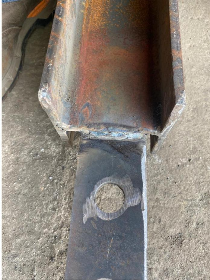
Socavación en viga
