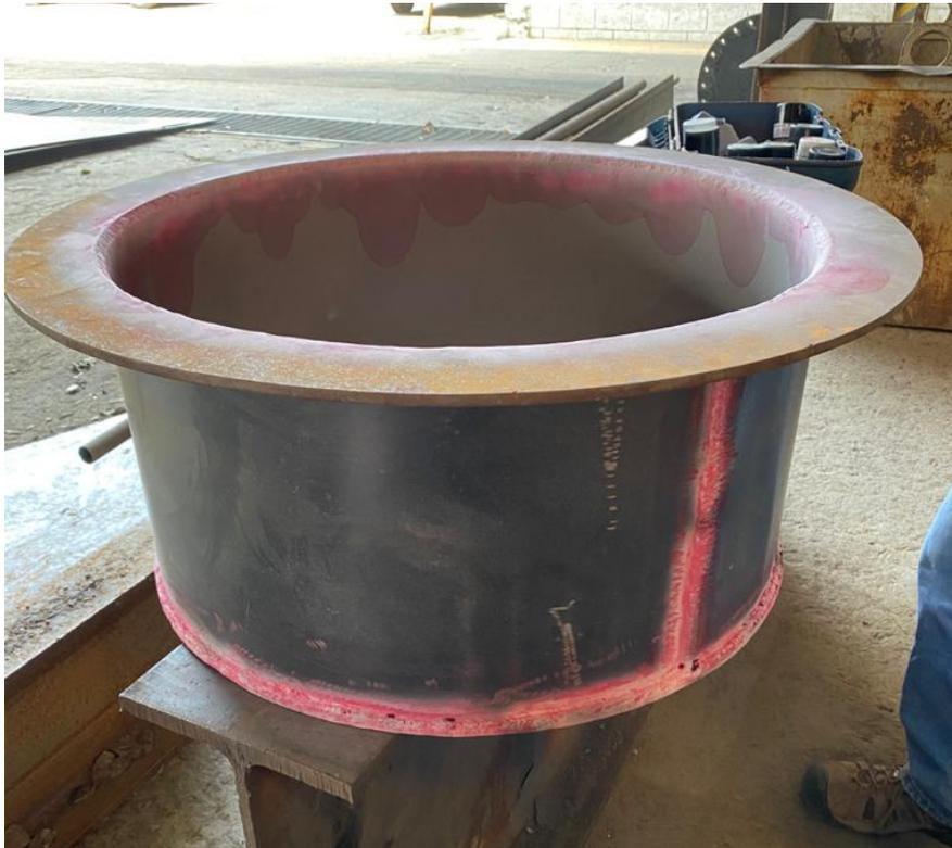
Prueba de tinta penetrante a sumideros de tanques
