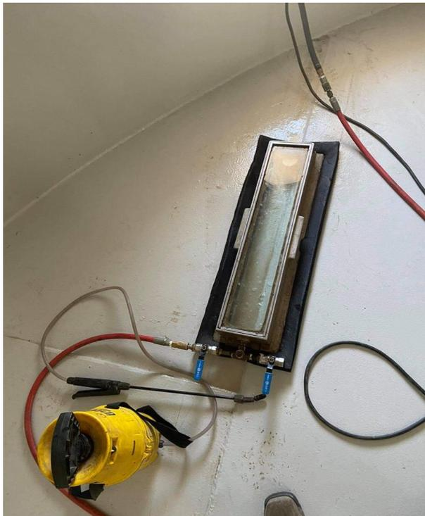
Prueba de vacío a tanque
