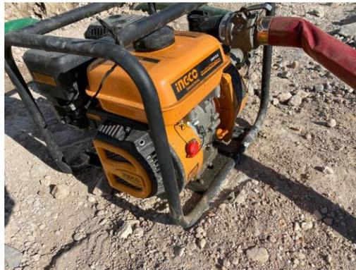
**Ilustración 32- Bomba achicadora.**
