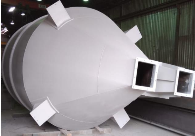
Figura 3: A continuación, se puede observar que a la tolva se le repararon los defectos encontrados y se le dio su acabado final en pintura para poder ser enviada al proyecto correspondiente.
