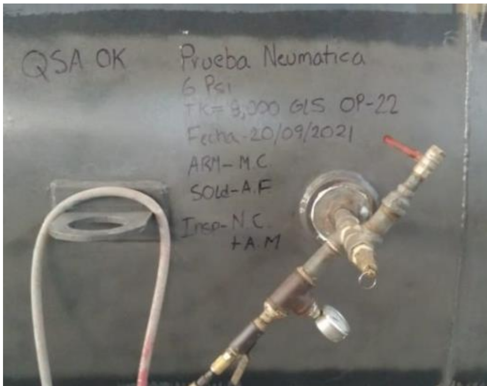
Figura 2: Aquí se logra apreciar la prueba de vacío al tanque de 8,000 galones que hice en el área de enfibrado de tanques para poder tener registro y evidencia, que se entrega al cliente junto con los tanques en el lugar del proyecto.
