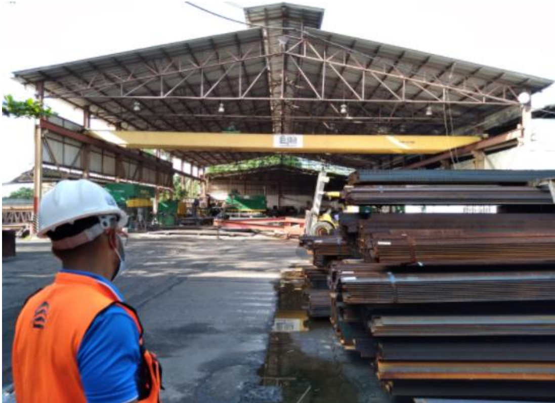
Figura 3: Aquí se logra apreciar al Ing. Johan Reyes dándome un recorrido por el área de preparación donde se hacen cortan placas usando máquinas de oxicorte y máquinas para perforar las mismas placas y que encajen en las uniones entre dos piezas estructurales donde usarían pernos.
