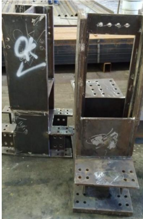
Figura 9: En esta imagen se encuentra un par de piezas estructurales metálicas para el proyecto de la torre de control del Aeropuerto de Palmerola por parte del cliente UTE CONSORCIO ELECENOR, y que en las cuales no se encontraron ningún tipo de problema en ellas por lo cual colocamos con un spray las letras "OK".
