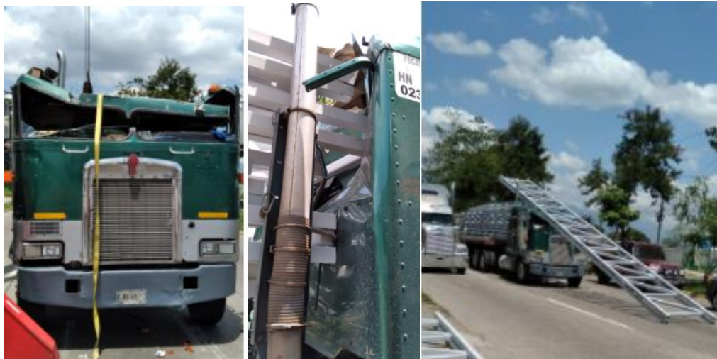
Figura 6: A continuación, se miran tres imágenes la primera es como se veía la parte de enfrente del cabezal del camión, la siguiente como los Joists fueron a dar a la parte de atrás del cabezal del camión, y la 3era ya una vista general de cómo estaba cuando se llegó a la escena del accidente, este evento ocurrió en la CA5 enfrente del AGAS.
