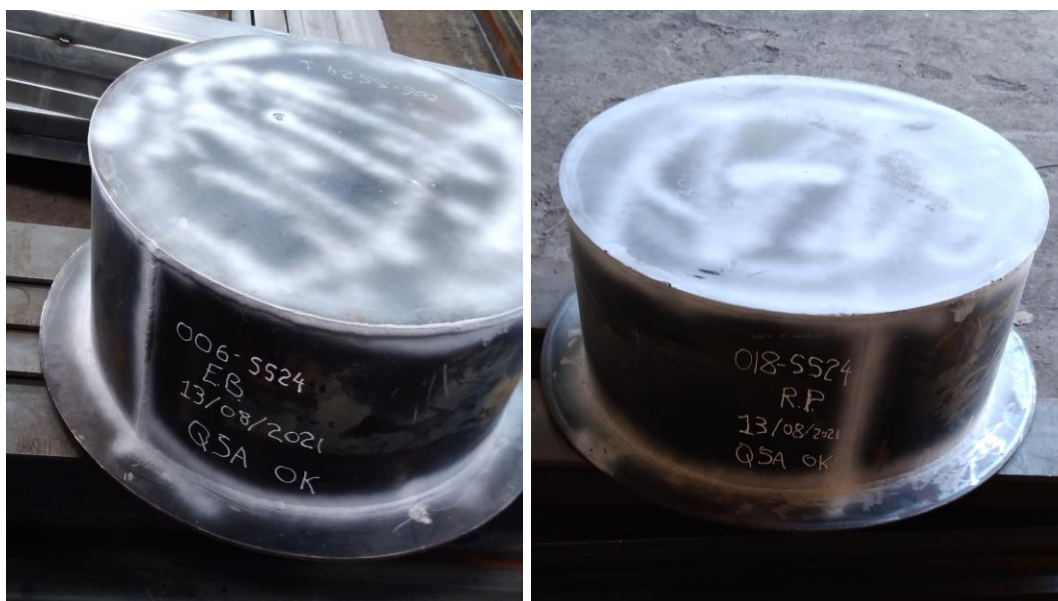
Figura 8: En estas dos imágenes se encuentran las evidencias de los dos sumideros de los dos tanques a los cuales se les hizo la prueba no destructiva con la inspección por tintas penetrantes para ver si había algún tipo de fuga o filtraciones.
