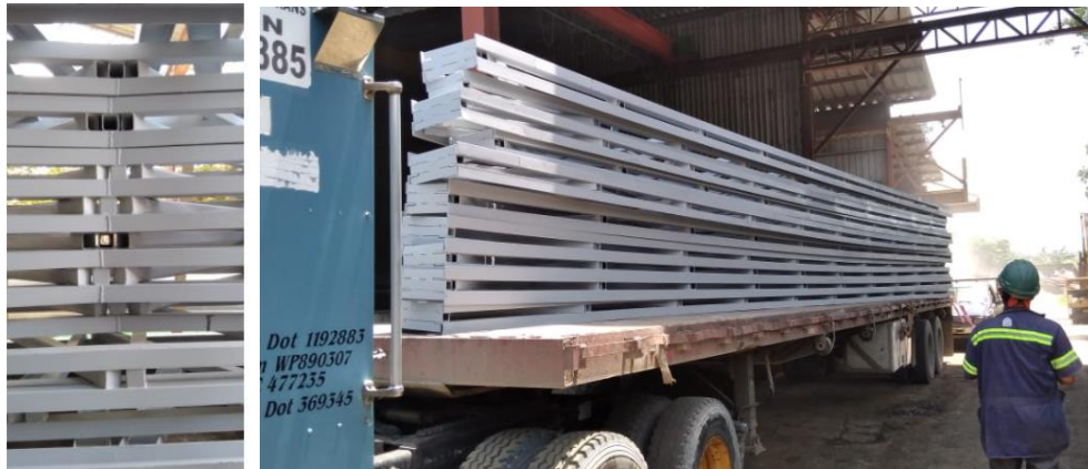
Figura 3: A continuación, se puede observar el despacho de 10 tijeras y que del total había unas 4 que no iban con el diseño actualizado según planos de técnica por el hecho que no llevaban tapones, siempre se mandaron, pero era bueno tenerlo en mente por si llegan a reclamar algo en campo, estas estructuras ya estaban en el proceso de su acabado final cuando técnica bajo actualizados los nuevos diseños.
