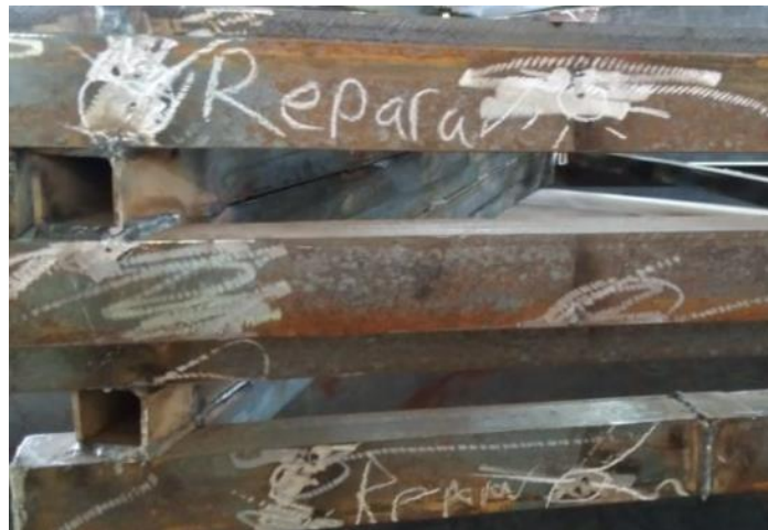
Figura 2: Aquí se logran apreciar unas marcas con tizas y partes "reparadas" usando la pulidora, pero no siempre hacen un buen trabajo puliendo por lo que siempre quedan detalles en las piezas que es mejor señalárselos y que lo reparen de nuevo.
