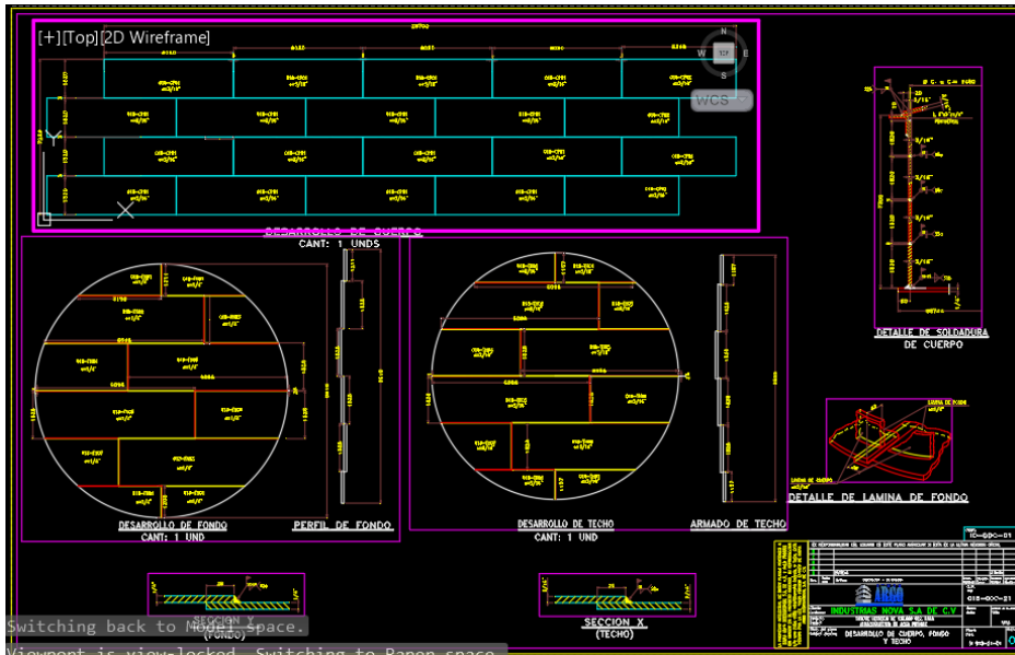
Ilustración 16 Fondo, Cuerpo y Techo de Tanque de Agua Potable
