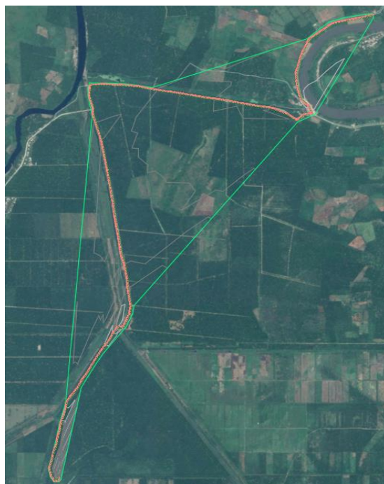
Ilustración 11. Ruta de Línea de Distribución
