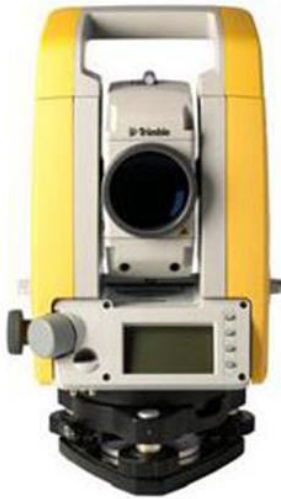
Ilustración 15. Estación Total Trimble M3
