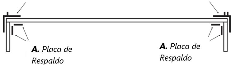
Para las conexiones de acero de A hasta la K (exceptuando el pin conector), se utiliza el perno, la arandea plana y la tuerca (v. *página 40*) para asegurarlos a la estructura de madera. Se muestra a continuación las configuraciones del perno:
