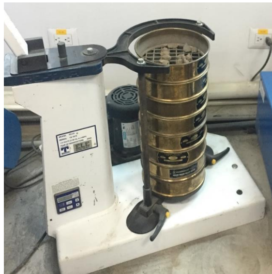
Ilustración 6 - Tamizado de la muestra de suelo haciendo uso de un agitador mecánico
