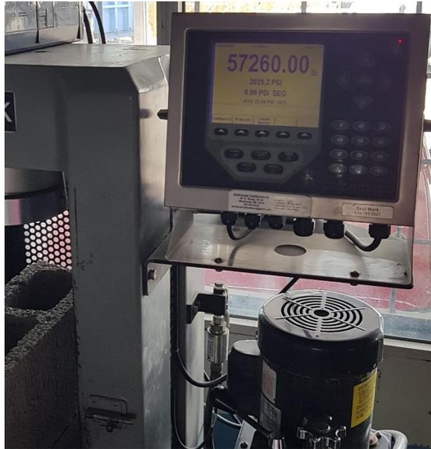
**Ilustración 106. Lectura de Bloque 10% PET+Aditivo #1 en la máquina de compresión**
