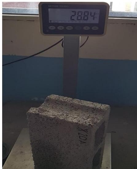
**Ilustración 123. Peso del Bloque 20% PET con Aditivo #2**
