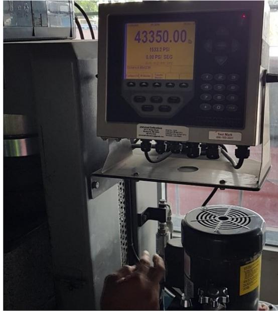
**Ilustración 124. Lectura de Bloque 20% PET con Aditivo #2 en la máquina de compresión**
