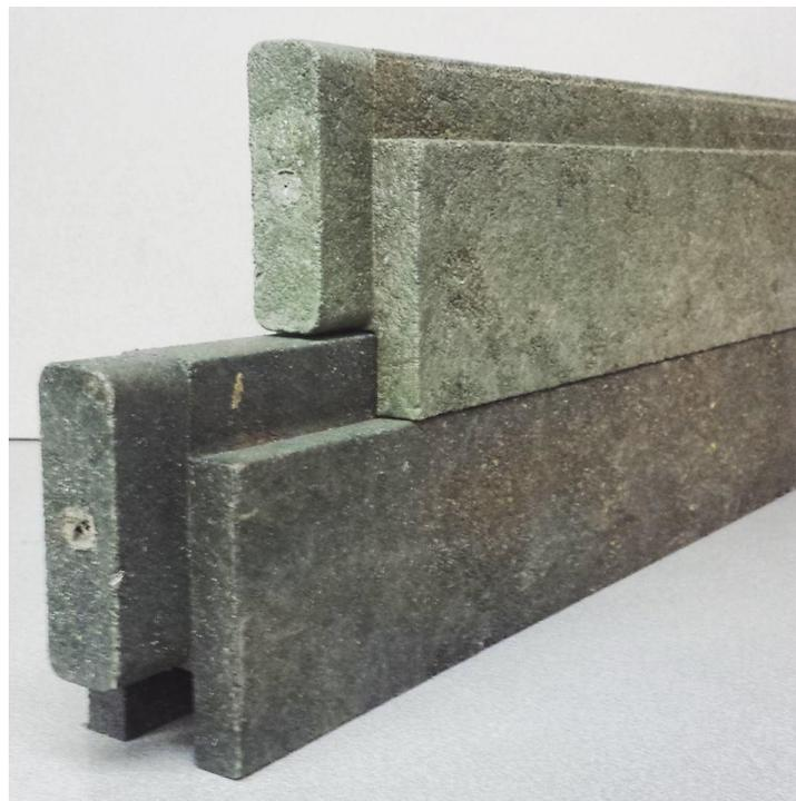
**Ilustración 4. Plástico reciclado convertido en ladrillos**
