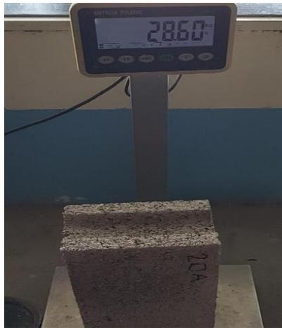
**Ilustración 121. Peso del Bloque 20% PET con Aditivo #1**
