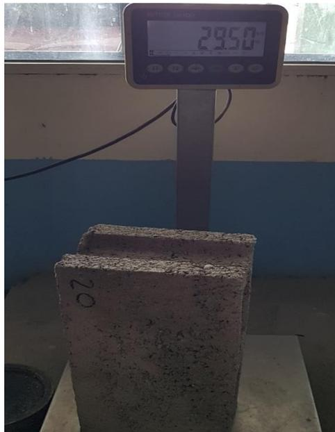
**Ilustración 115. Peso del Bloque 20% PET #2**
