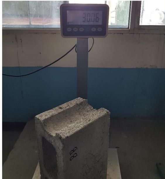
**Ilustración 91. Peso del Bloque Control #1**
