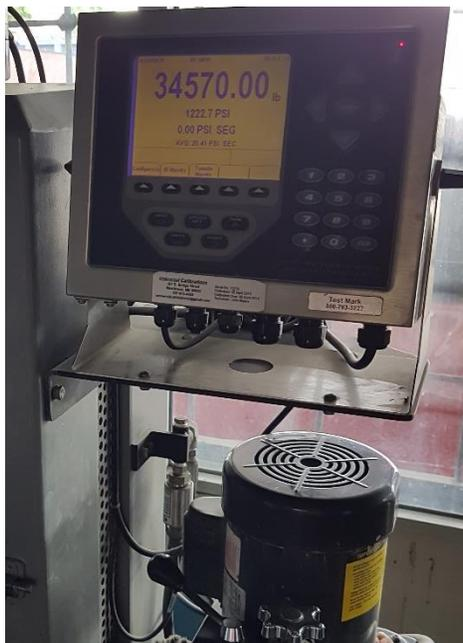
**Ilustración 122. Lectura de Bloque 20% PET con Aditivo #1 en la máquina de compresión**
