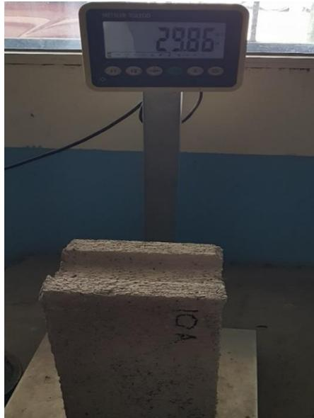
**Ilustración 111. Peso del Bloque 10% PET con Aditivo #4**
