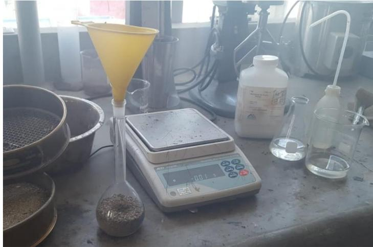
**Ilustración 57. Paso #6 para Gravedad Específica de la Arena**
