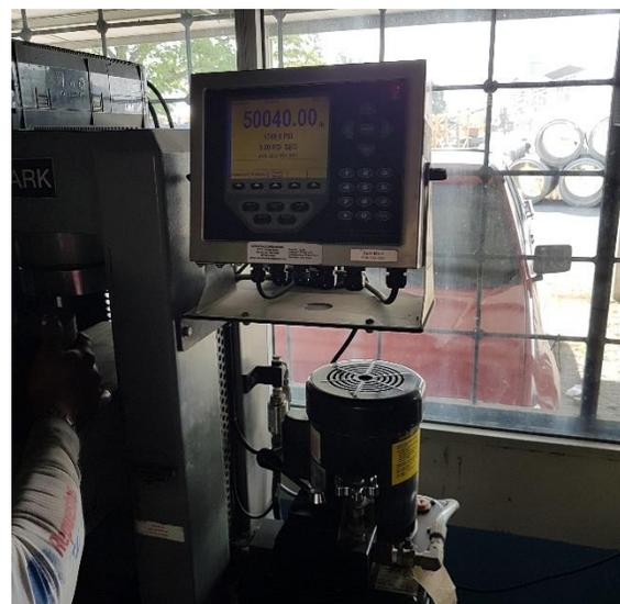
**Ilustración 92. Lectura de Bloque Control #1 en la máquina de compresión**
