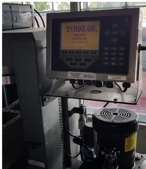
**Ilustración 108. Lectura de Bloque 10% PET+Aditivo #2 en la máquina de compresión**
