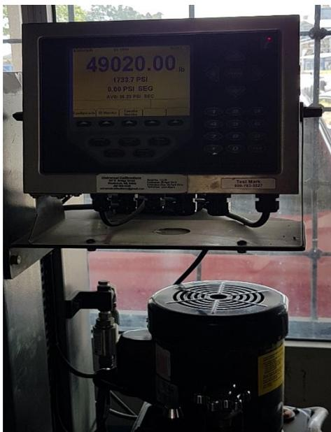
**Ilustración 98. Lectura de Bloque Control #4 en la máquina de compresión**
