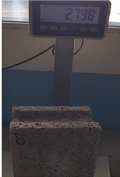
**Ilustración 117. Peso del Bloque 20% PET #3**
