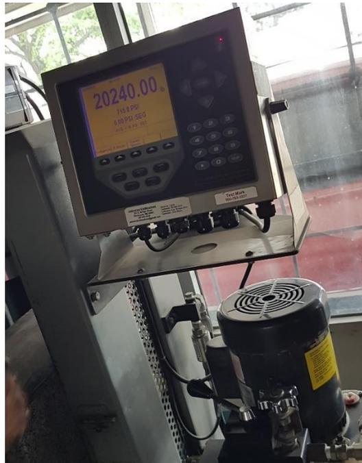
**Ilustración 132. Lectura de Bloque 30% PET #2 en la máquina de compresión**
