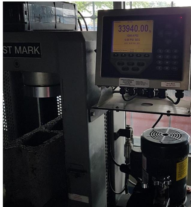
**Ilustración 128. Lectura de Bloque 20% PET con Aditivo #4 en la máquina de compresión**
