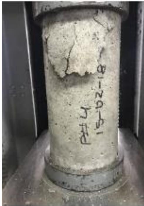
**Ilustración 22. Cilindro Mezcla con 30% plástico**
