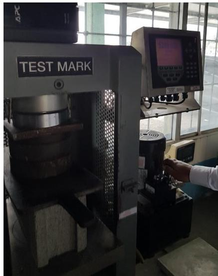
**Ilustración 67. Colocación de Bloque en máquina de compresión**
