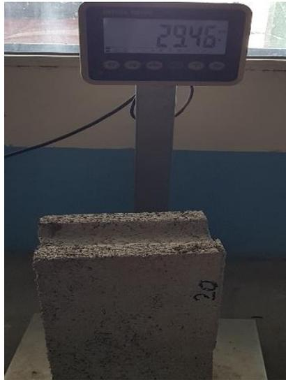
**Ilustración 113. Peso del Bloque 20% PET #1**
