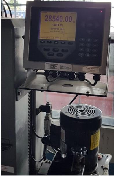
**Ilustración 120. Lectura de Bloque 20% PET #4 en la máquina de compresión**
