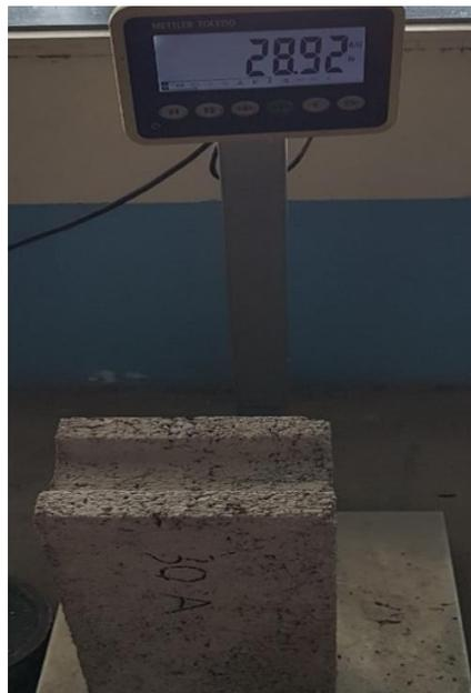
**Ilustración 141. Peso del Bloque 30% PET con Aditivo #3**
