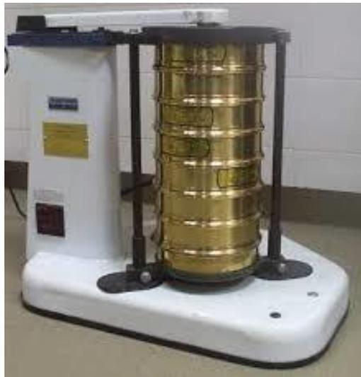
**Ilustración 30. Tamizado Mecánico**
