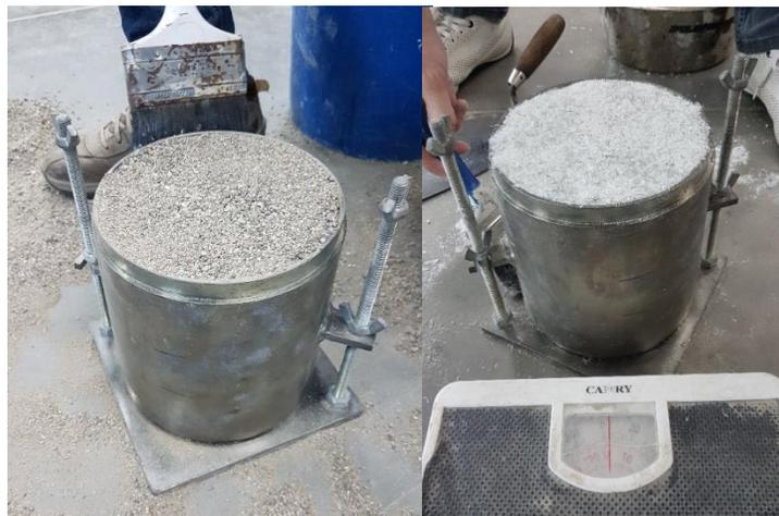
**Ilustración 50. Ensayo de Peso Volumétrico en agregados fino método de la varilla**
