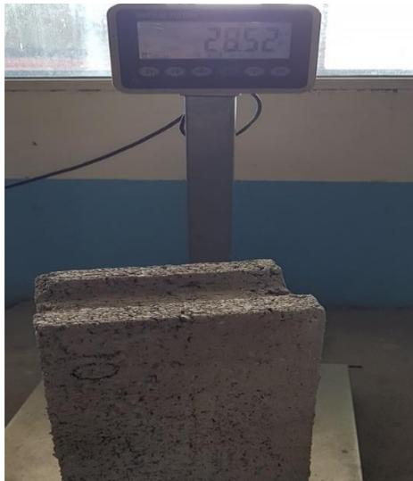
**Ilustración 103. Peso del Bloque 10% PET #3**
