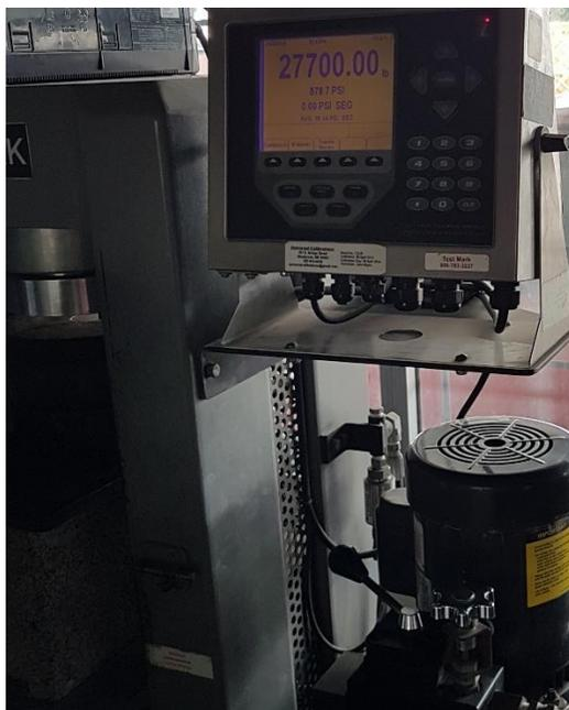
**Ilustración 130. Lectura de Bloque 30% PET #1 en la máquina de compresión**
