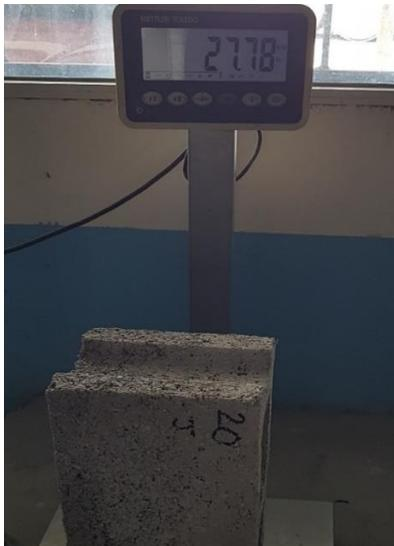
**Ilustración 119. Peso del Bloque 20% PET #4**
