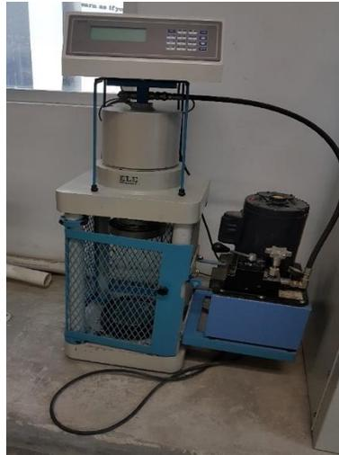
**Ilustración 43. Máquina de Compresión**
