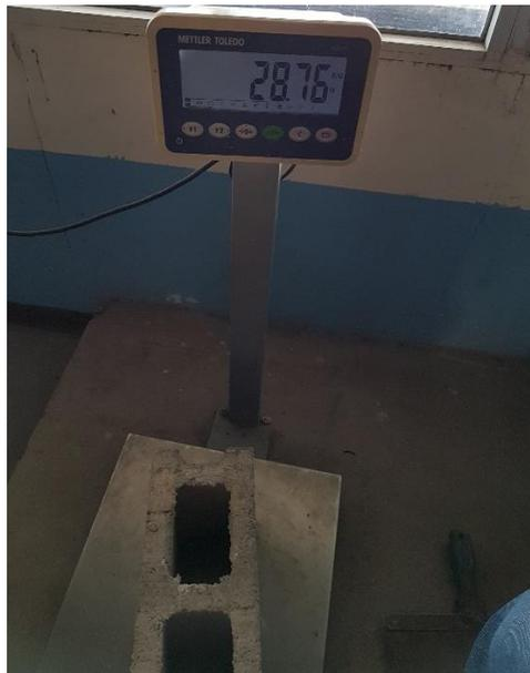
**Ilustración 93. Peso del Bloque Control #2**
