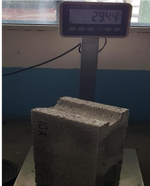
**Ilustración 107. Peso del Bloque 10% PET con Aditivo #2**
