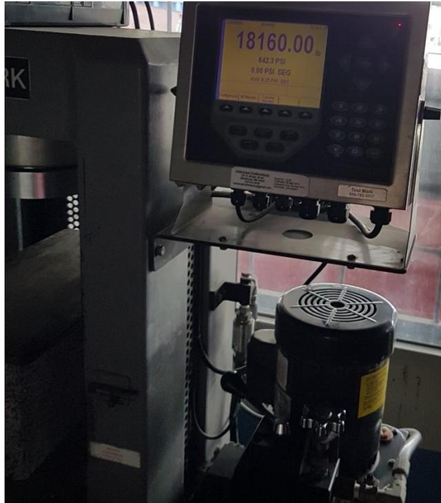
**Ilustración 136. Lectura de Bloque 30% PET #4 en la máquina de compresión**
