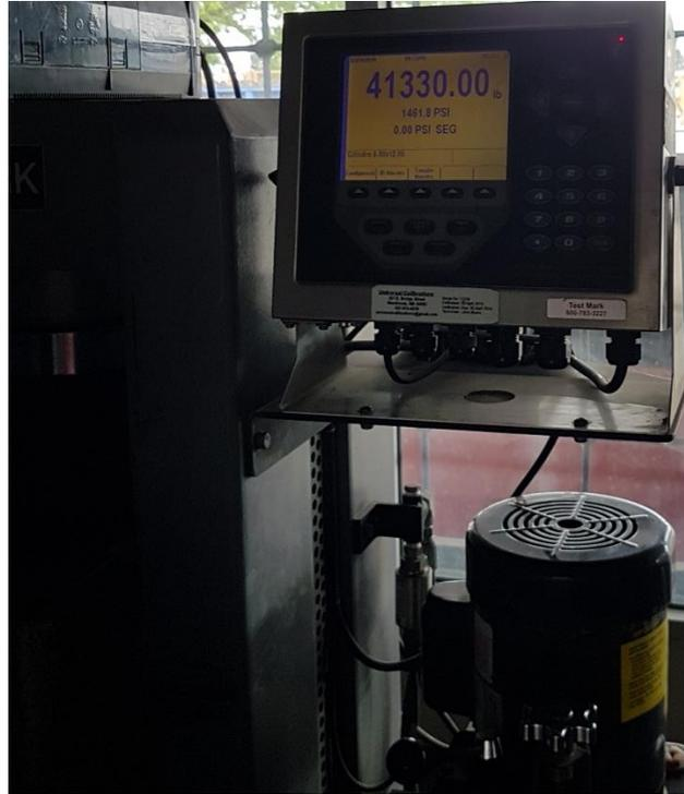
**Ilustración 144. Lectura de Bloque 30% PET con Aditivo #4 en la máquina de compresión**
