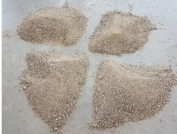
**Ilustración 48. Cuarteo del agregado Fino**
