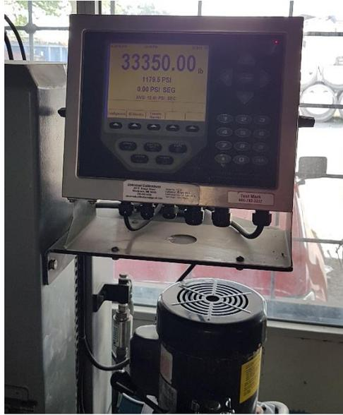
**Ilustración 94. Lectura de Bloque Control #2 en la máquina de compresión**
