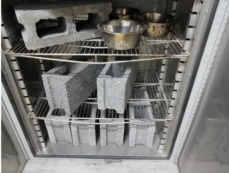
**Ilustración 90. Proceso de secado de los bloques al horno**
