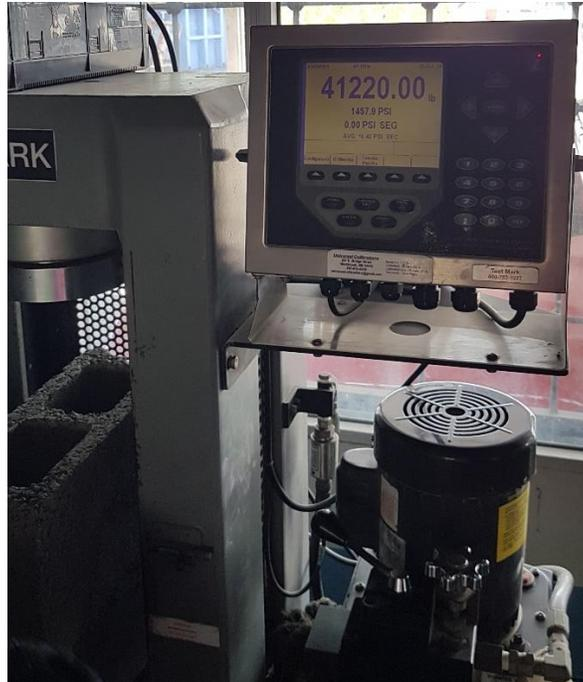
**Ilustración 104. Lectura de Bloque 10% PET #3 en la máquina de compresión**
