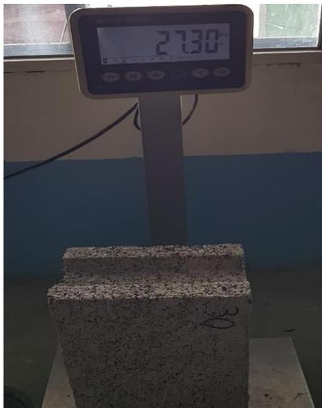
**Ilustración 129. Peso del Bloque 30% PET #1**
