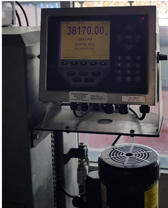
**Ilustración 116. Lectura de Bloque 20% PET #2 en la máquina de compresión**
