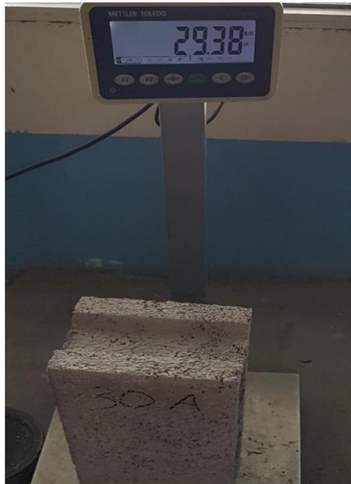
**Ilustración 143. Peso del Bloque 30% PET con Aditivo #4**
