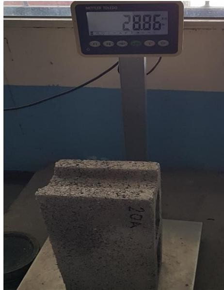
**Ilustración 125. Peso del Bloque 20% PET con Aditivo #3**
