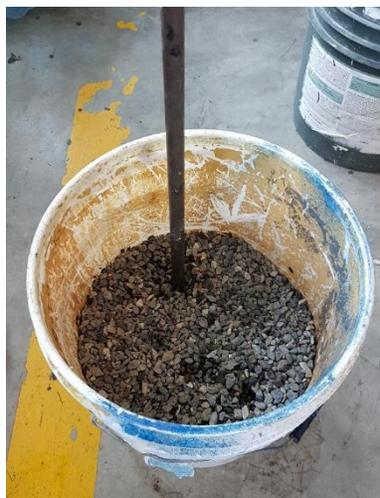
**Ilustración 51. Ensayo de Peso Volumétrico en gravilla**
