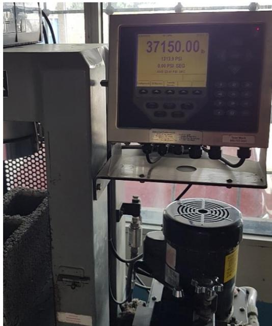
**Ilustración 118. Lectura de Bloque 20% PET #3 en la máquina de compresión**
