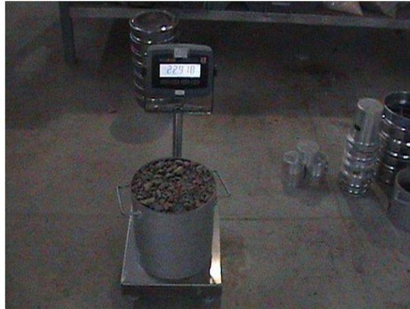
**Ilustración 31. Ejemplo de ensayo de peso Volumétrico**
