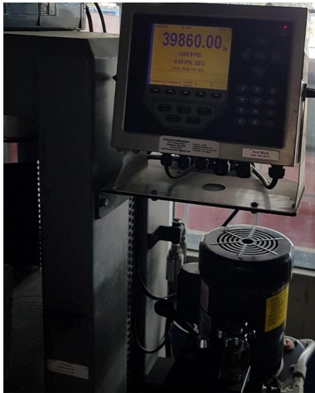
**Ilustración 142. Lectura de Bloque 30% PET con Aditivo #3 en la máquina de compresión**
