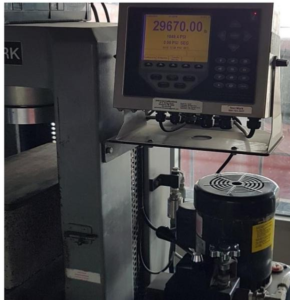
**Ilustración 126. Lectura de Bloque 20% PET con Aditivo #3 en la máquina de compresión**
