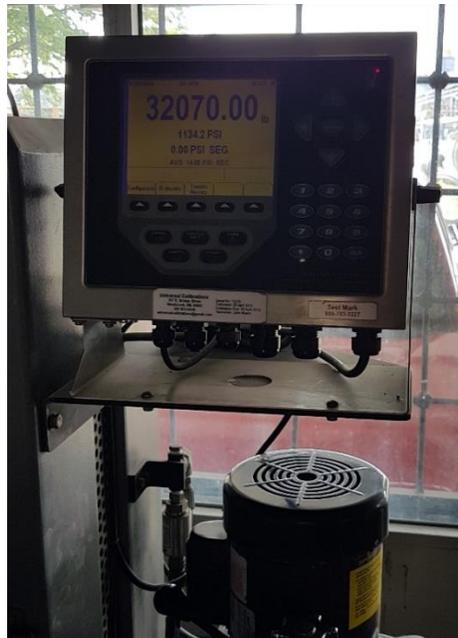
**Ilustración 96. Lectura de Bloque Control #3 en la máquina de compresión**
