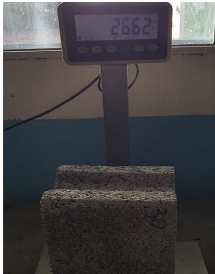
**Ilustración 133. Peso del Bloque 30% PET #3**
