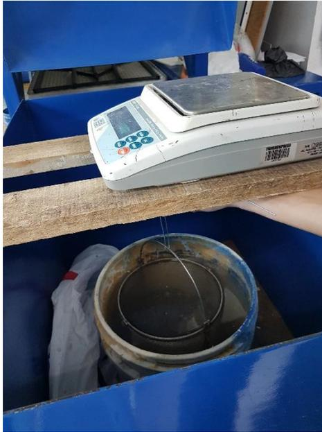
**Ilustración 58. Ensayo de Gravedad Específica de la Gravilla**
