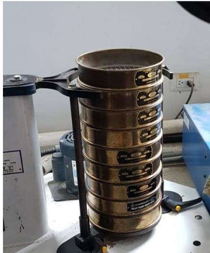
**Ilustración 53. Granulometría de agregados**
