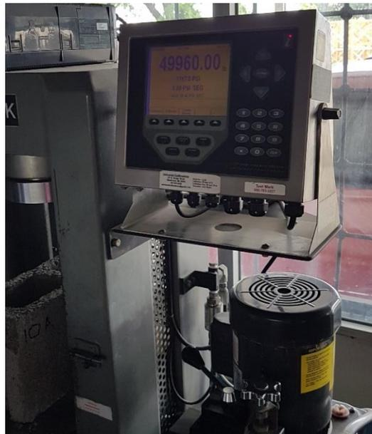
**Ilustración 112. Lectura de Bloque 10% PET+Aditivo #4 en la máquina de compresión**
