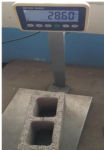
**Ilustración 99. Peso del Bloque 10% PET #1**
