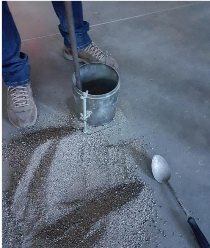
**Anexo 11. Método del Varillado para Peso Volumétrico de la arena**
