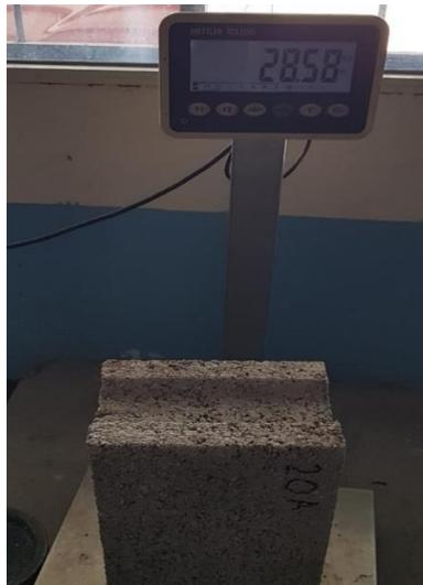
**Ilustración 127. Peso del Bloque 20% PET con Aditivo #4**
