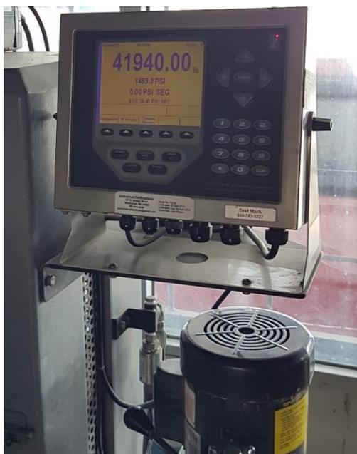
**Ilustración 110. Lectura de Bloque 10%+Aditivo #3 en la máquina de compresión**
