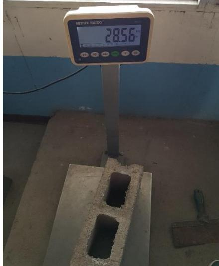
**Ilustración 95. Peso del Bloque Control #3**
