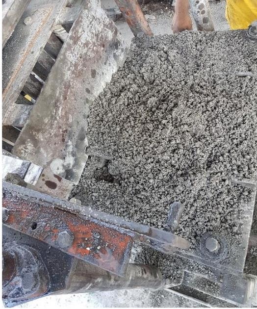
**Ilustración 62. Mezcla en la máquina de bloques**
