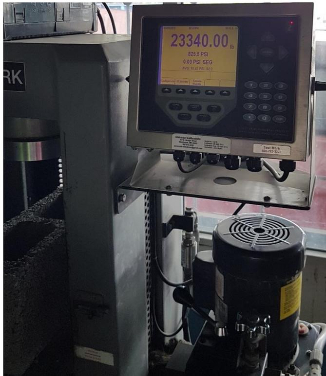
**Ilustración 134. Lectura de Bloque 30% PET #3 en la máquina de compresión**
