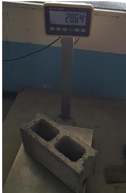
**Ilustración 101. Peso del Bloque 10% PET #2**
