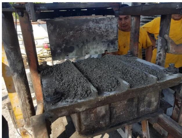
**Ilustración 44. Máquina Artesanal de Bloques**
