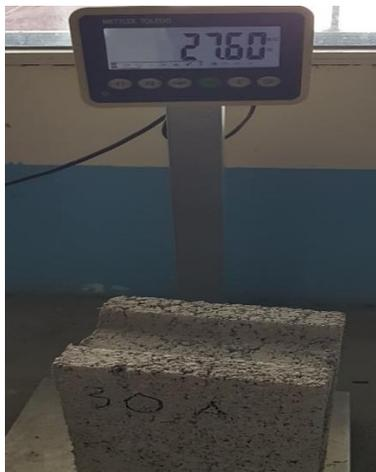
**Ilustración 137. Peso del Bloque 30% PET con Aditivo #1**
