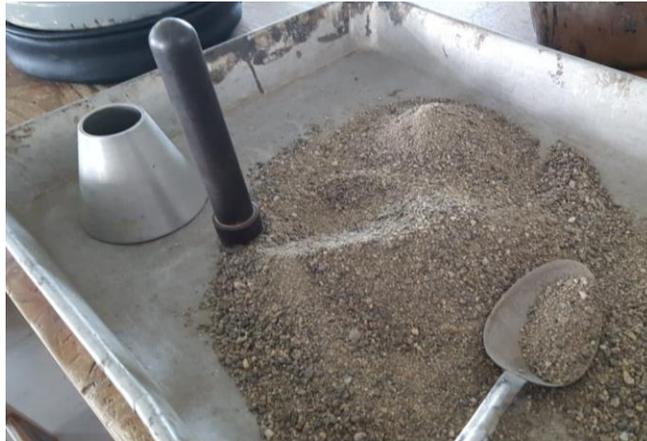
**Ilustración 56. Paso #4 para Gravedad Específica de la Arena**
