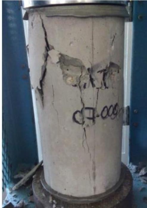
**Ilustración 18. Prueba a compresión de testigo**
