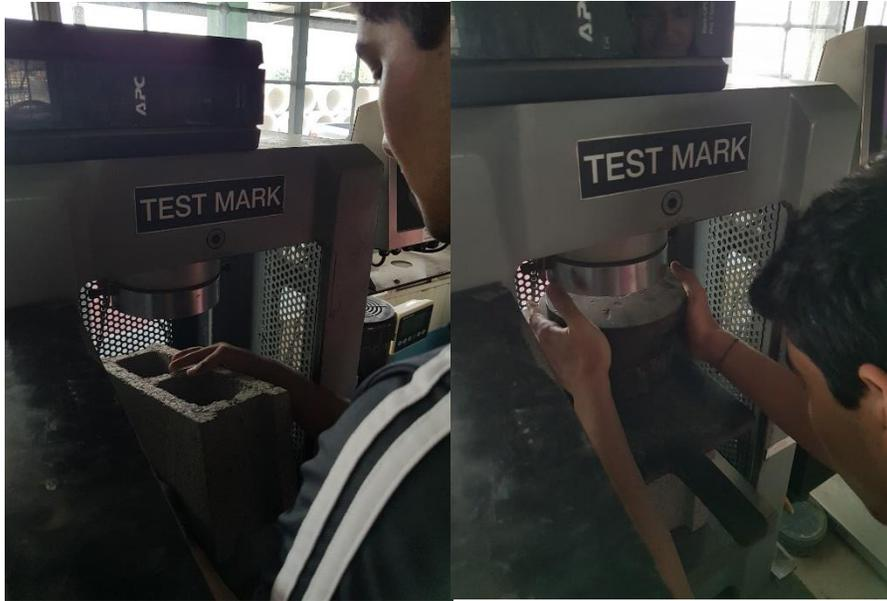
**Ilustración 66. Colocación de Bloque en máquina de compresión**
