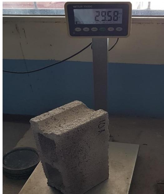
**Ilustración 109. Peso del Bloque 10% PET con Aditivo #3**
