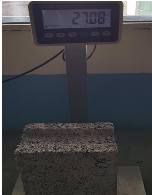
**Ilustración 135. Peso del Bloque 30% PET #4**
