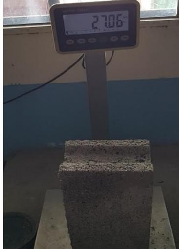
**Ilustración 131. Peso del Bloque 30% PET #2**
