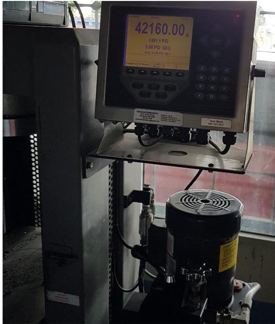
**Ilustración 138. Lectura de Bloque 30% PET con Aditivo #1 en la máquina de compresión**
