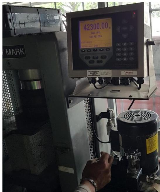
**Ilustración 140. Lectura de Bloque 30% PET con Aditivo #2 en la máquina de compresión**
