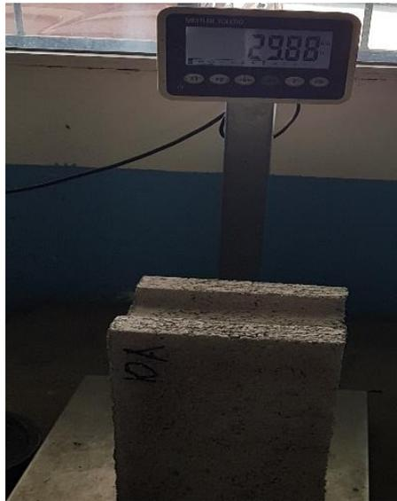
**Ilustración 105. Peso del Bloque 10% PET con Aditivo #1**
