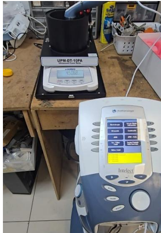
Ilustración 17: Calibraciones de sonda de Intellect Advanced
