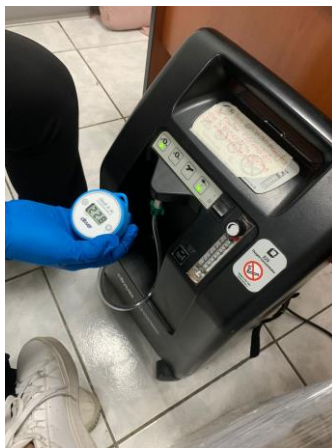
Ilustración 21: Cantidad de O 2 entregada por el concentrador de oxígeno.
