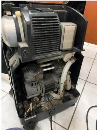
Ilustración 20: Interior del concentrador de oxígeno.
