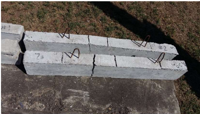
Figura 67. Vigas con 10% de plástico
