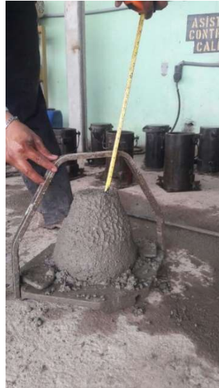
Figura 18. Revenimiento mezcla con 10% de plástico.
