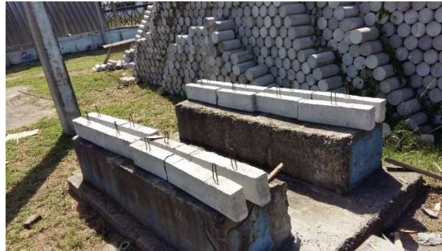
Figura 51. Vigas al finalizar el ensayo.
