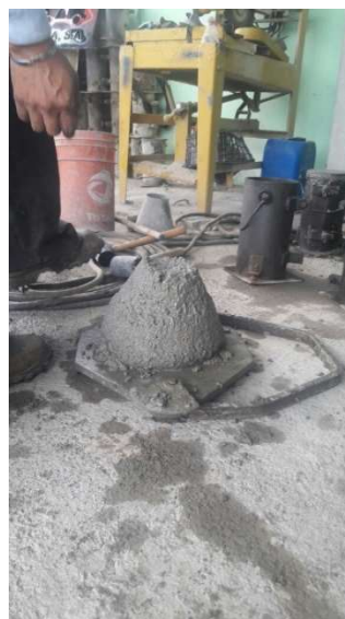
Figura 19. Revenimiento mezcla con 20% de plástico.
