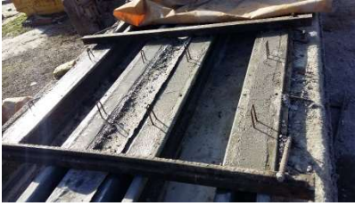
Figura 45. Vigas control (derecha) y vigas mezcla 10% (izquierda).
