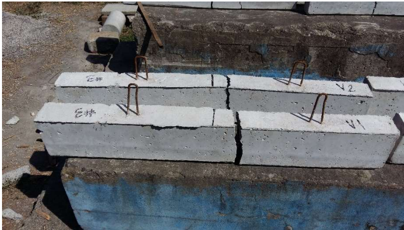
Figura 62. Vigas con 20% de plástico
