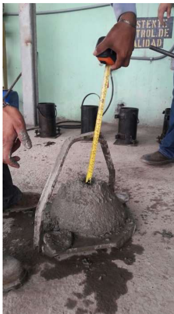
Figura 17. Revenimiento mezcla control.
