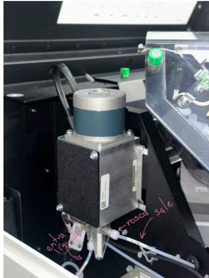
Anexo 1. Cambio de bomba de jeringa – Architect Plus
