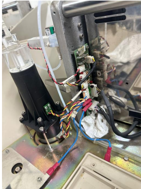
Anexo 15. Conexiones de motor de pistón a A15
