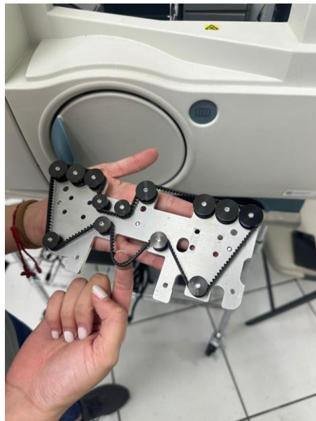
Anexo 41. Mantenimiento preventivo en Vitek
