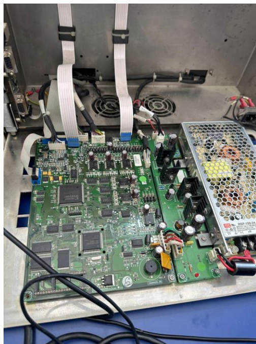
Anexo 8. Tarjeta de alimentación y tarjeta de CPU – A15 Tela
