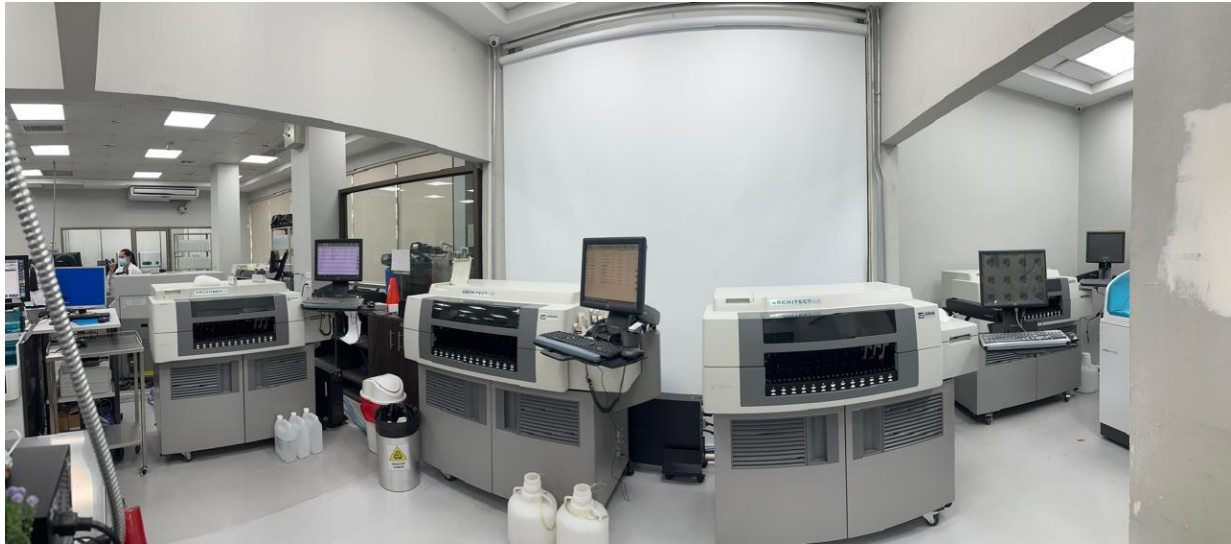
Anexo 38. Instalación de dos Architech i1000SR Laboratorio Bueso Arias
