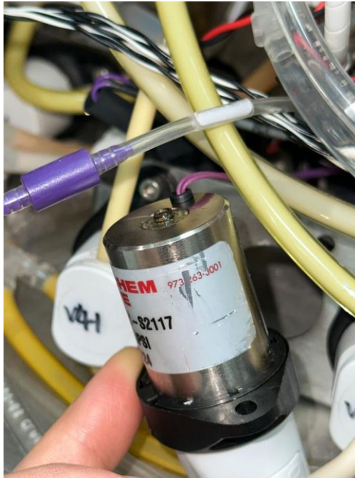
Anexo 40. Verificación de lubricación de válvulas en Alinity Hq LBA
