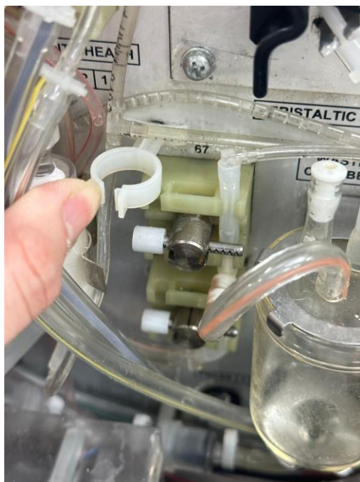
Anexo 23. Cambio de válvula 67 en Ruby (LBA)
