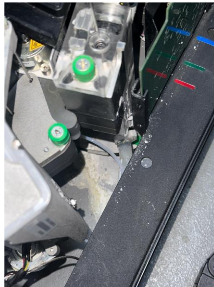
Anexo 36. Corrosión equipo i1000SR Hospital Bendaña
