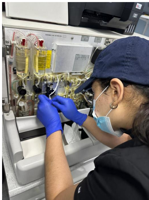
Anexo 10. Cambio de la manguera peristáltica – Hospital Bendaña
