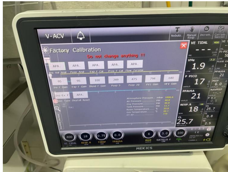
Ilustración 53: Menú de Calibración por Ganancias en Ventilador MEKICS MV2000
