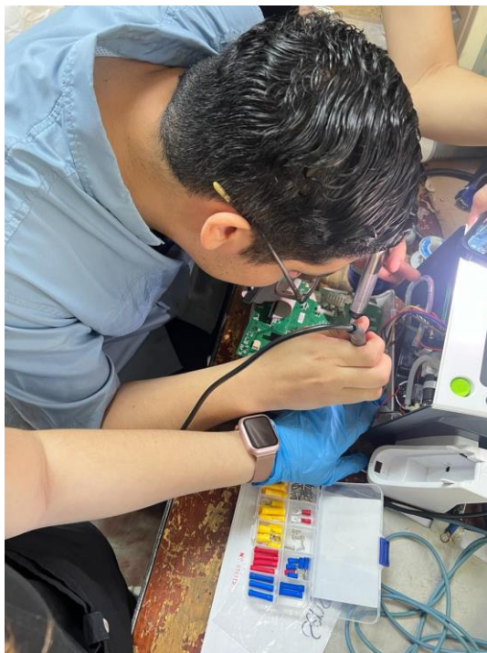
Ilustración 38: Retiro de la Soldadura de Puerto SpO2 en MSV VTrust
