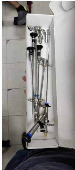
Ilustración 28: Lentes de Cistoscopio Sucios
