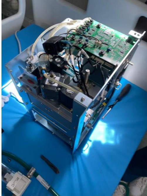
Ilustración 31: Interior de Ventilador Mecánico en Oncología Pediátrica
