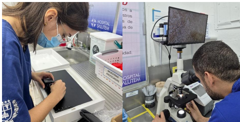
Ilustración 22 - Instalación de pantalla y cámara para microscopio, instalación de software, verificación de funcionamiento.
