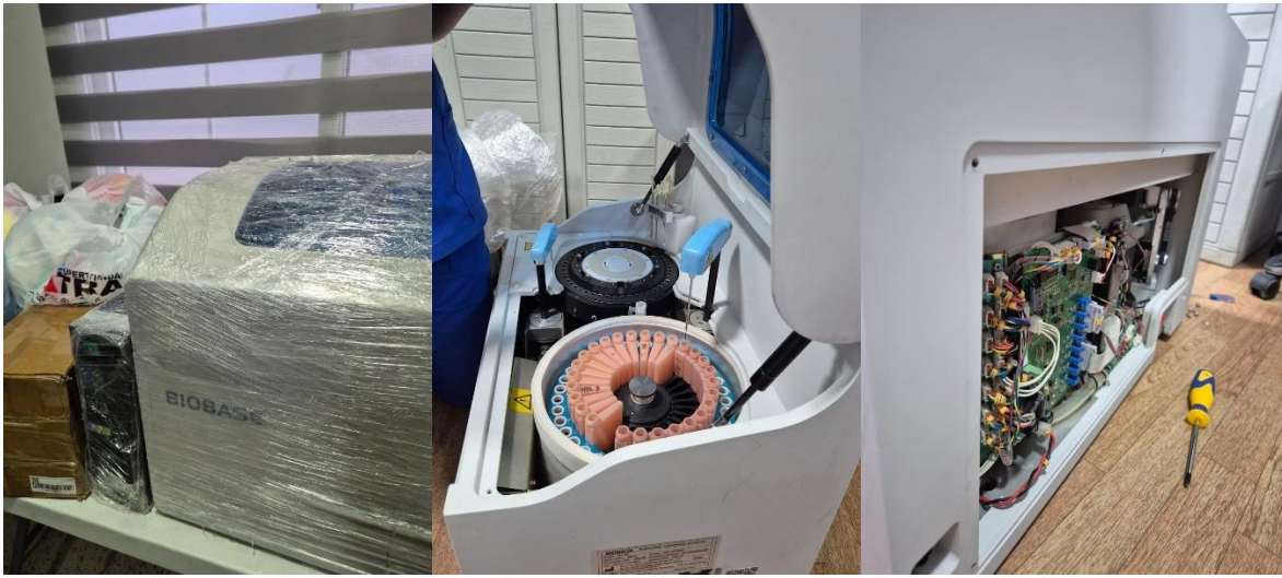
Ilustración 64 - Revisión de Analizador de Química por humedad
