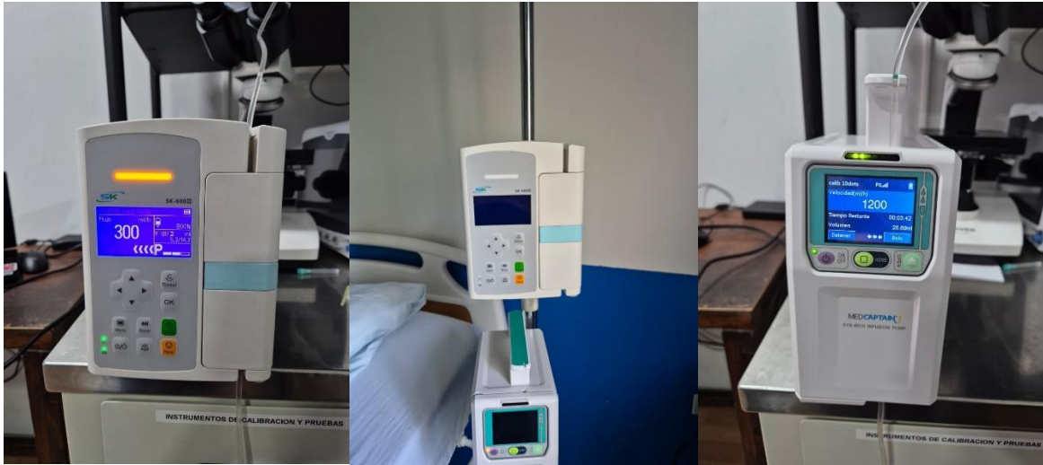
Ilustración 38 - Calibración y mantenimiento preventivo a bombas de infusión
