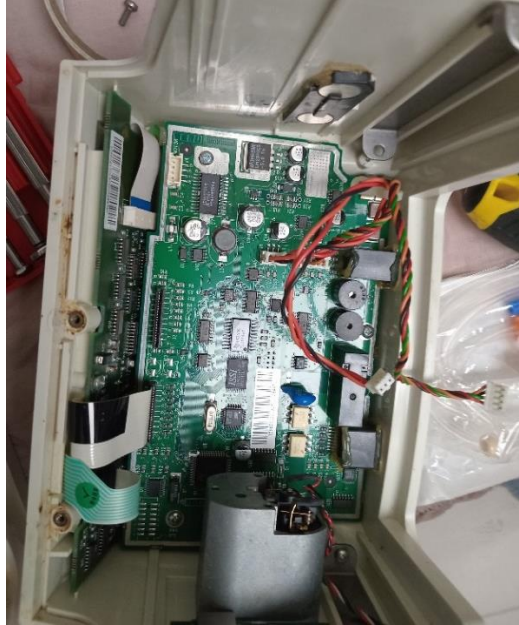
Ilustración 23: Inspección y Reemplazo de Componentes Internos en Bomba de Infusión, Marca Fresenius, Modelo Optima
