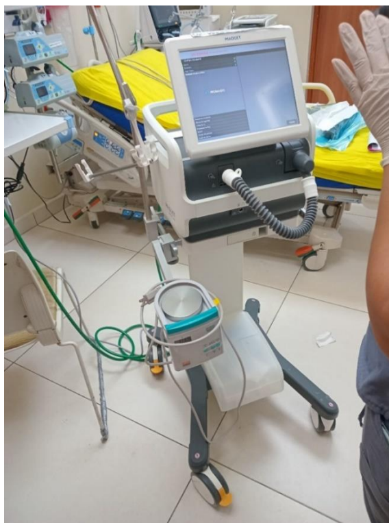
Ilustración 8: Realización de Prueba de Funcionamiento Preliminar en Ventilador Mecánico
