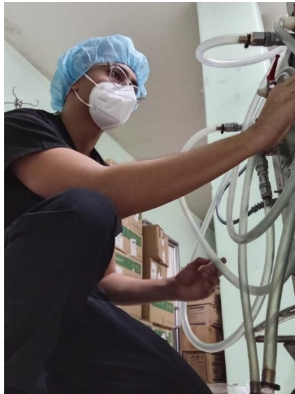
Ilustración 20: Ensamblaje de Mangueras en Intercambiador de Calor Marca-Stöckert, Modelo-Liva Nova 3T Heater-Cooler
