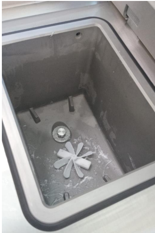
Ilustración 47: Drenado de Retorta en Procesador de Tejidos
