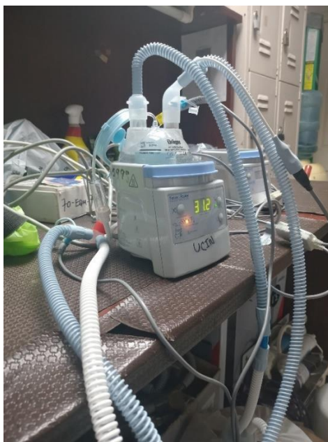
Ilustración 19: Pruebas de Funcionamiento en Humidificadores Respiratorios, Marca Fisher & Paykel Healthcare, Modelo MR850JSU
