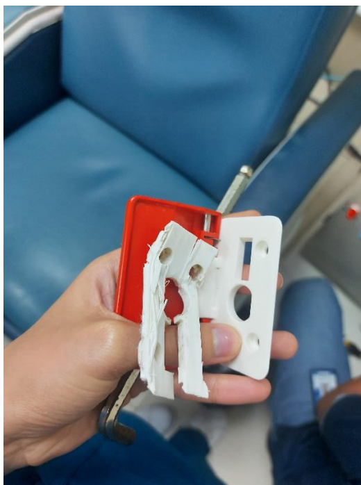
Ilustración 57-Reemplazo de tapadera de conexión de pipeta de ácido
