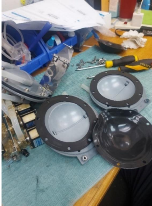
Ilustración 17- Cámara de balance (Máquina Diamax)
