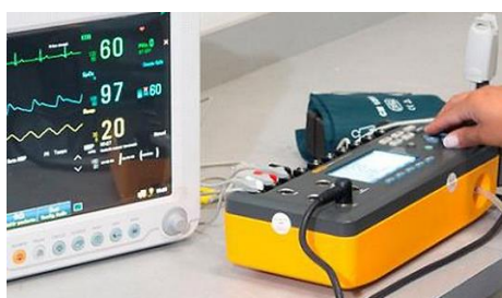
Ilustración 3- Mantenimiento preventivo de monitor de signos vitales
