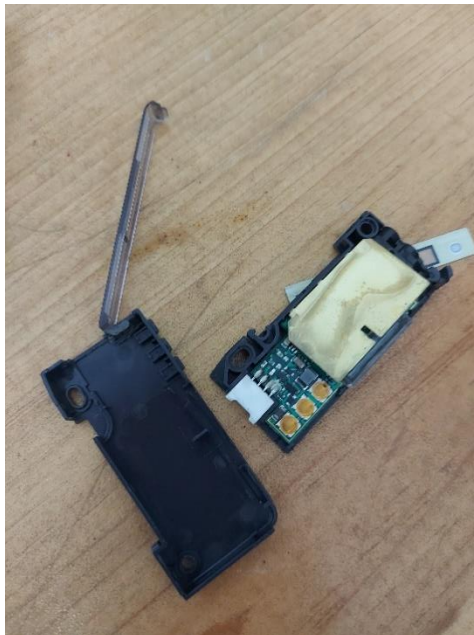
Ilustración 28- Revisión interna de sensor fx-101
