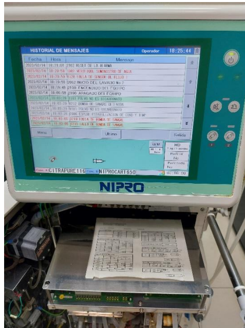
Ilustración 39- Alarma "Falla de sensor de flujo 1"
