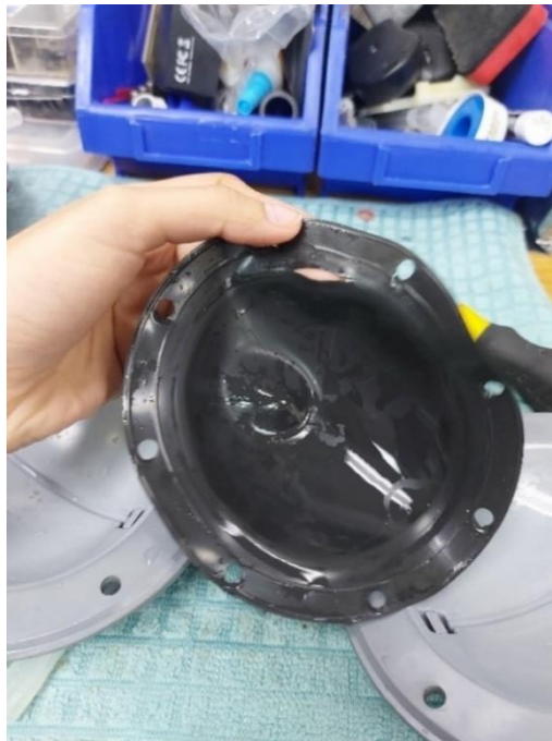
Ilustración 18- Diafragma roto de cámara de balance
