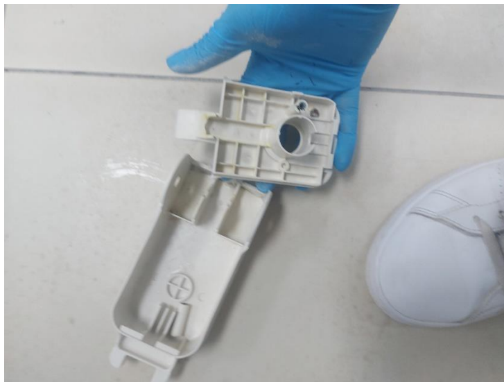
Ilustración 38- Pieza de brazo de bicarbonato dañada
