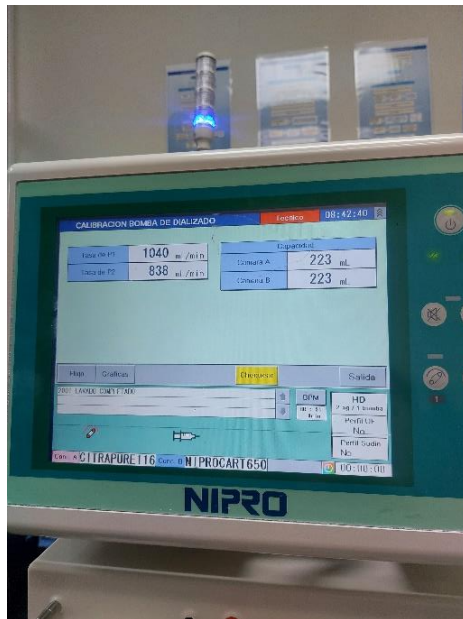
Ilustración 26- Calibración de bomba de dializado
