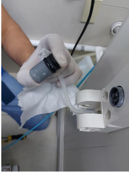
Ilustración 50-Reemplazo de pieza de brazo de bicarbonato máquina #05
