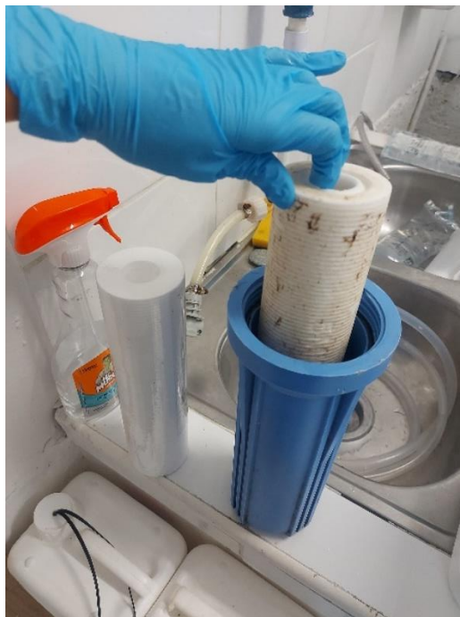
Ilustración 49-Cambio de filtro de 5micras a la osmosis portátil #2
