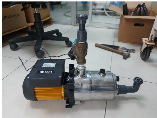
Ilustración 64- Ensamblaje de bomba centrífuga
