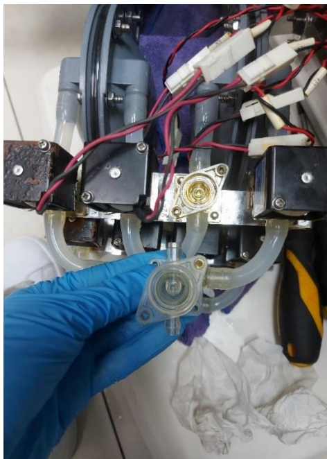
Ilustración 54-Reemplazo de la base de válvula #24
