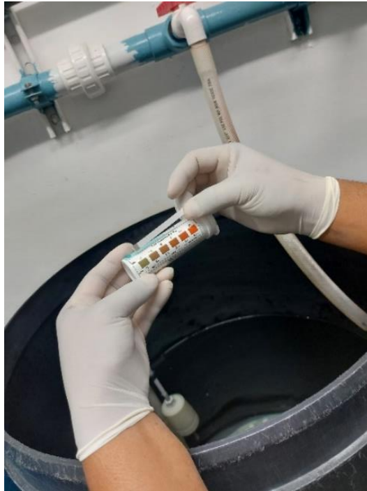
Ilustración 12- Prueba de dureza residual
