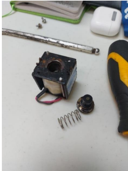
Ilustración 78- Válvula #15 con corrosión
