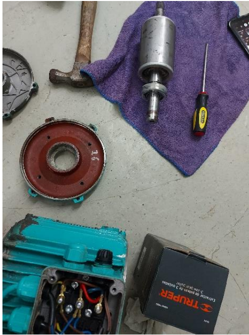
Ilustración 71- Colocación de balineras nuevas en motor de osmosis estacionaria.
