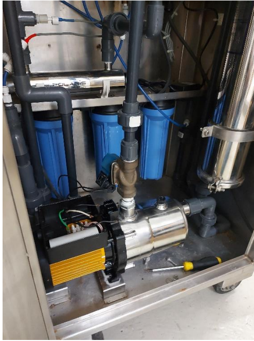
Ilustración 65- Conexión de la bomba en la osmosis portátil
