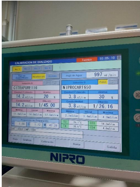
Ilustración 25- Calibración de soluciones de dializado
