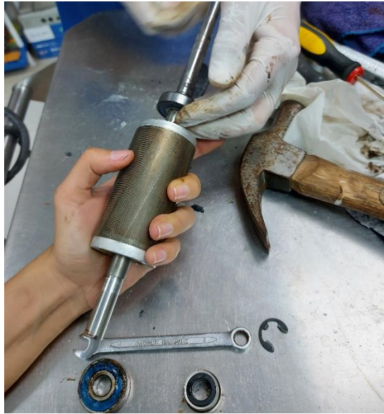
Ilustración 48- Extracción de las balineras del motor
