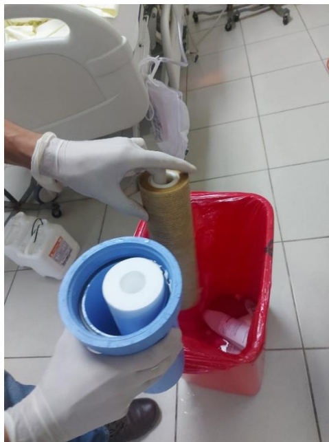
Ilustración 70- Cambio de filtro a osmosis portátil
