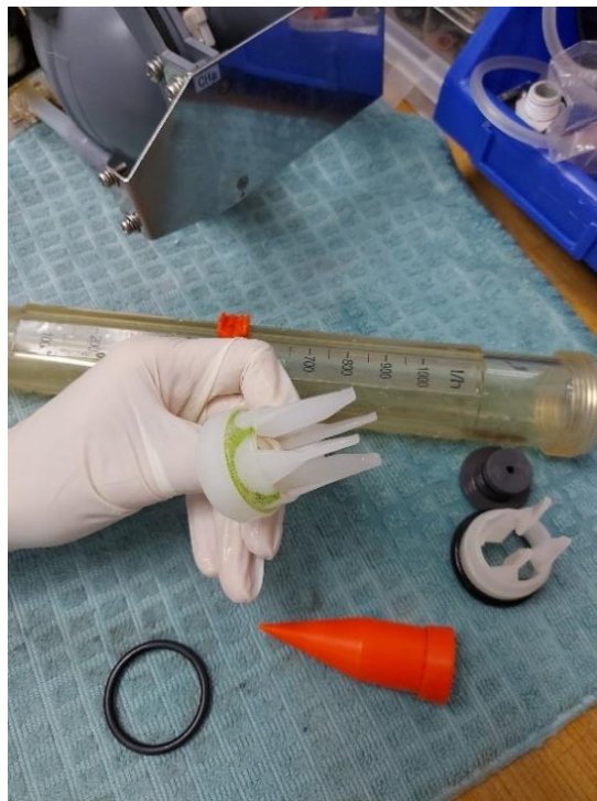
Ilustración 22- Limpieza de flujómetros de agua rechazo
