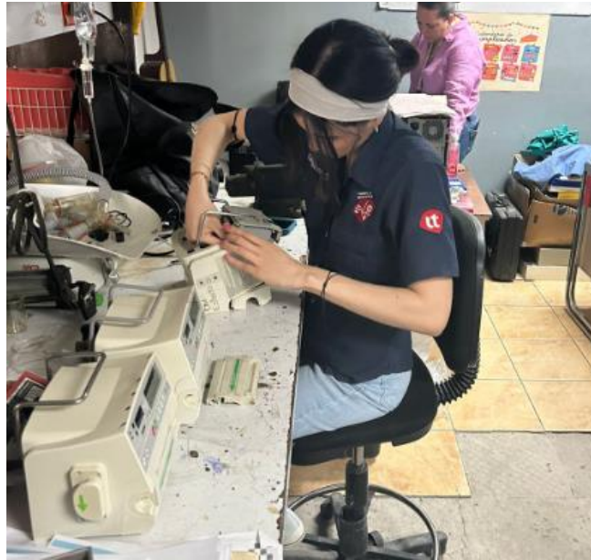
Ilustración 53 Mantenimiento Correctivo a Bombas de infusión E/O Pediátrica
