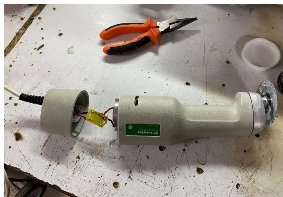
Ilustración 12 Mantenimiento correctivo sierra ortopedia
