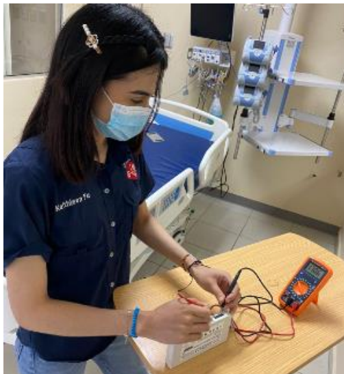
Ilustración 35 Medición de voltaje en la batería de ventilador mecánico
