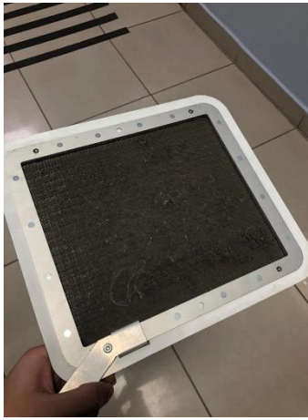
Ilustración 36 Filtro sucio de Ecógrafo.
