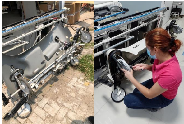
Ilustración 18 Cambio de ruedas de camilla
