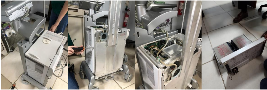
Ilustración 17 Proceso de retiro de baterías del datascopio CS100
