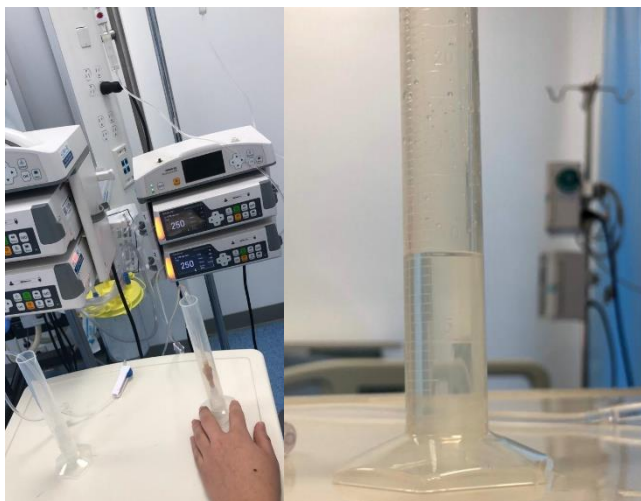
Ilustración 25 Calibración de Bombas de Infusión
