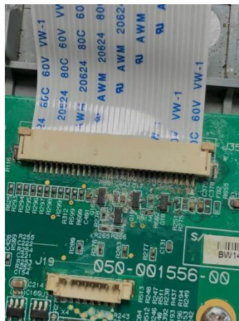
Ilustración 29 Placa de módulo de bombas dañada.
