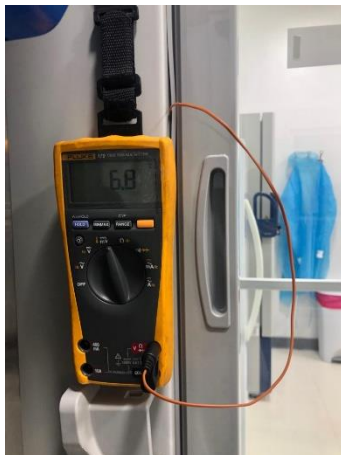
Ilustración 32 Verificación de enfriamiento de freezer con termocupla.
