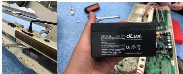
Ilustración 31 Ajuste de celdas y batería de cama hospitalaria.
