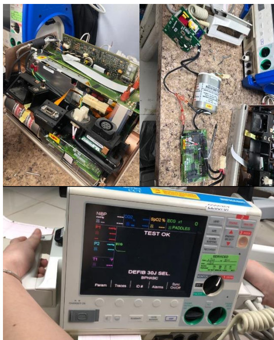
Ilustración 21 Cambio de módulo de voltaje en desfibrilador ZOLL M Series CCT
