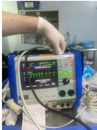
Ilustración 20 Falla 72 en desfibrilador ZOLL M Series CCT
