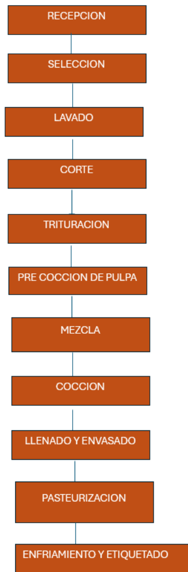
Figura 26 Diagrama del proceso para la producción de mermelada de Piña.
