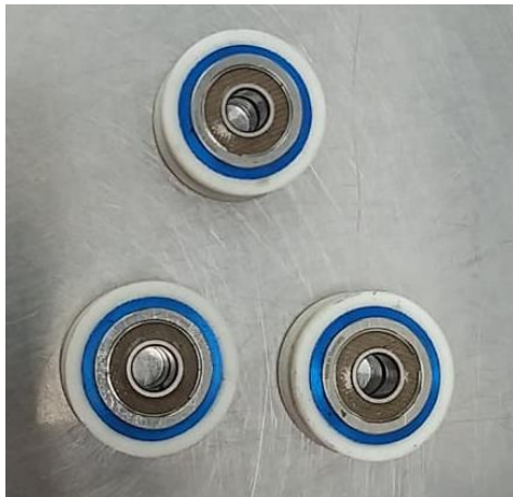
Ilustración 29: Poleas del carrusel de reactivos del i1000SR #2 (LBA)
