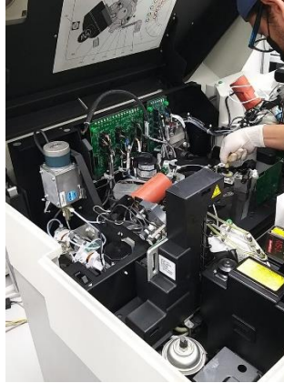
Ilustración 21: Mantenimiento preventivo i1000SR #1 (LBA)
