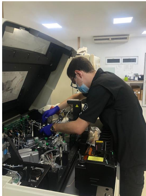
Ilustración 65: Mantenimiento preventivo de i1000SR (CEMESA)
