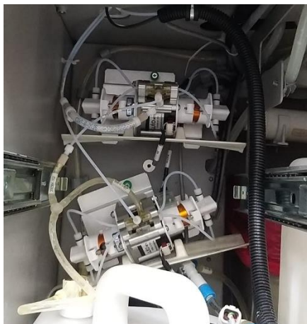
Ilustración 59: Bombas de buffer de lavado i1000SR #2 (LBA)
