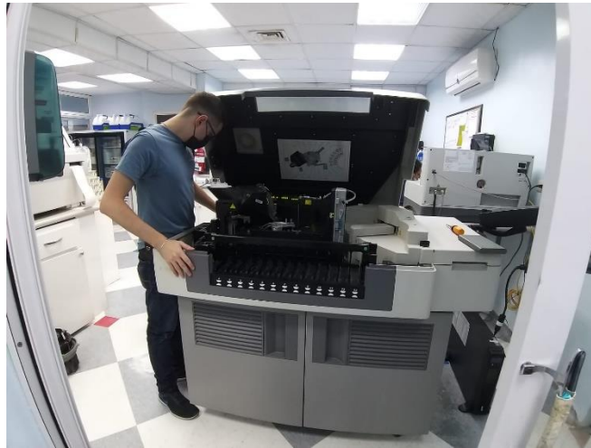
Ilustración 64: Mantenimiento preventivo de i1000SR (HB)
