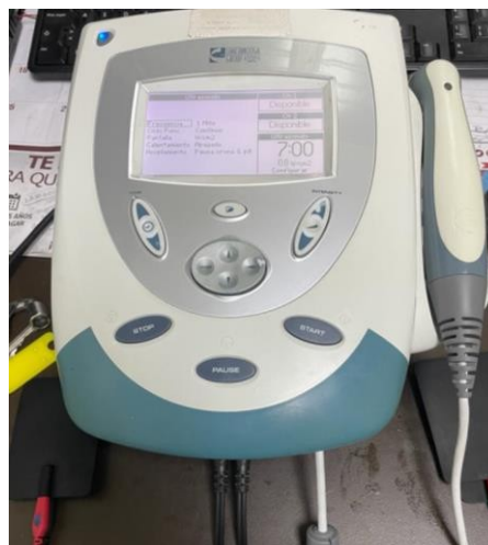
Ilustración 31. Prueba de equipo luego de reemplazo de placa de canal 1
