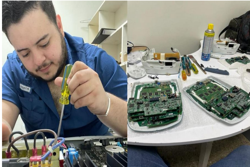
Ilustración 30. Desmontaje de placas de canal 1
