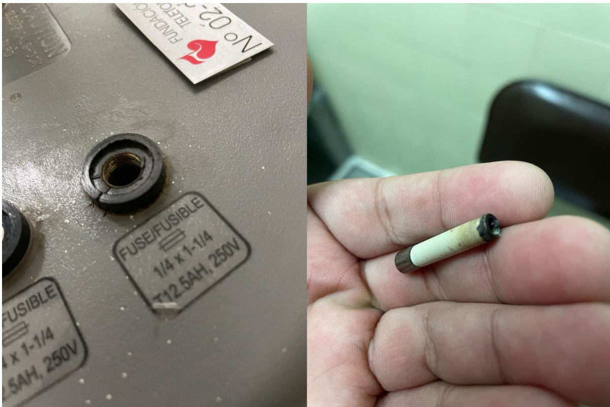
Ilustración 28. Fusible quemado de motor de hidroterapia
