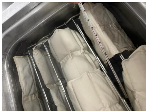
Ilustración 25. Toma de temperatura de compresero
