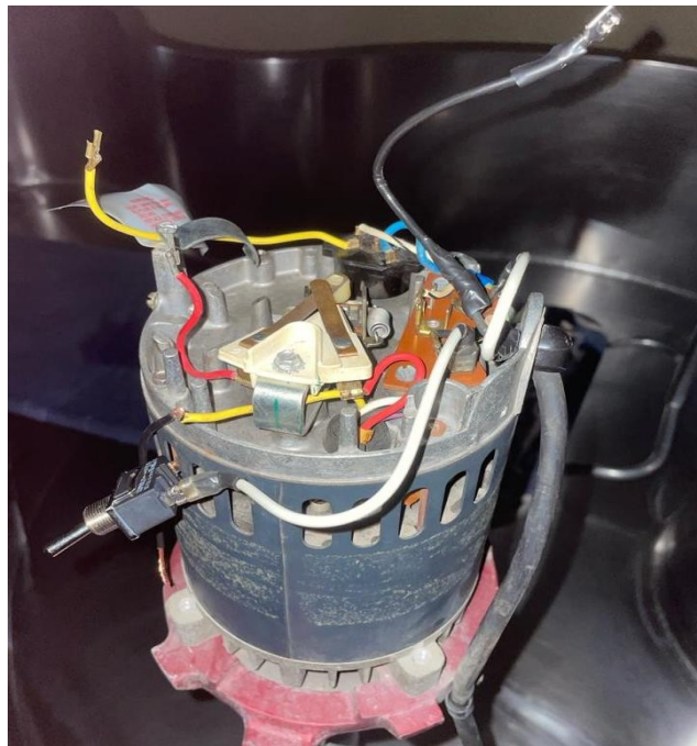
Ilustración 19. Interior de un motor de hidroterapia
