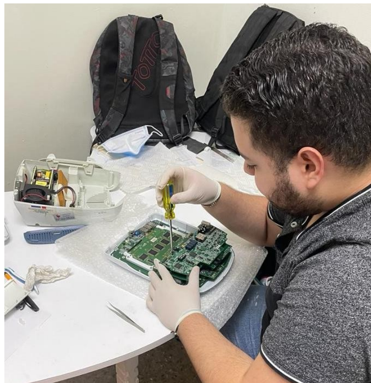
Ilustración 22. Mantenimiento preventivo a equipo de electroestimulación
