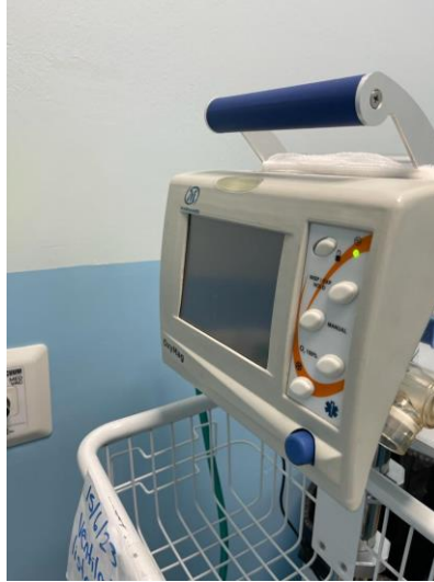
Ilustración 63 - VM con botón de bloqueo en mal estado.
