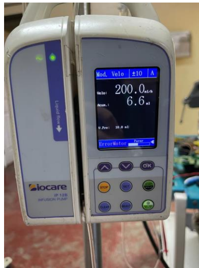
Ilustración 49 - Biocare con problemas en el motor
