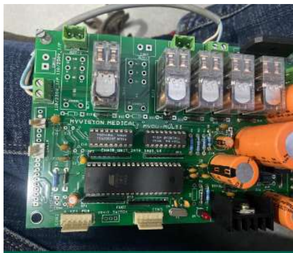
Ilustración 24. Placa electrónica camilla quirúrgica.
