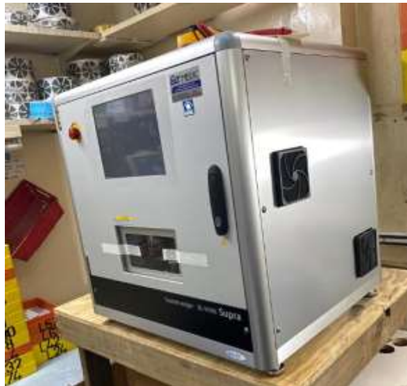
Ilustración 16. Instalación biseladora Supra.
