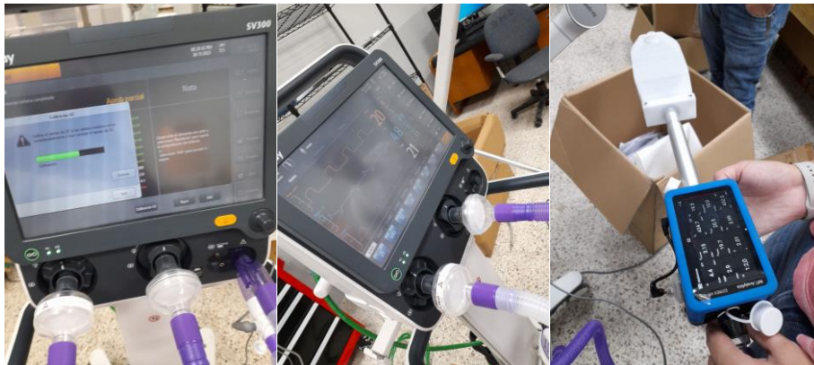
Anexo 14: Pruebas de funcionamiento de ventilador mecánico SV300
