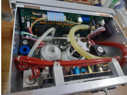
Ilustración 12: Insuflador por dentro
