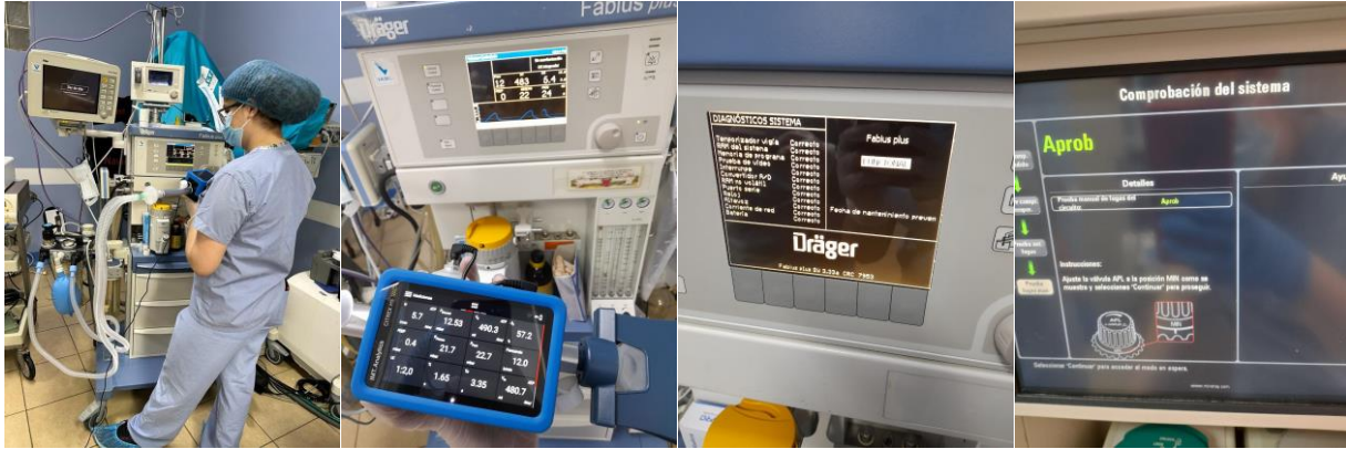
Ilustración 38: Pruebas de funcionamiento de máquinas de anestesia
