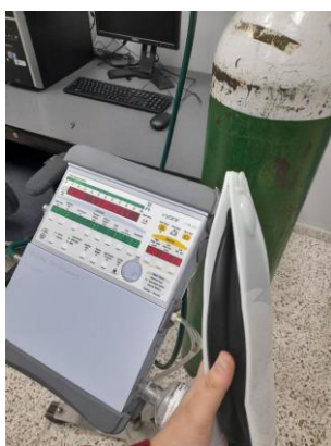
Ilustración 15: Ventilador mecánico LTV2 2200 en revisión
