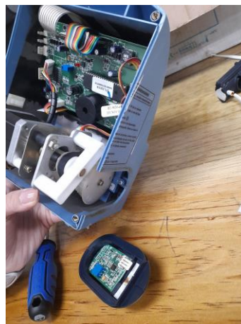
Ilustración 33: Cambio de sensor de aire en línea de bomba de infusión Samtronic
