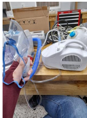
Anexo 8: Pruebas de funcionamiento de nebulizadores para lactantes
