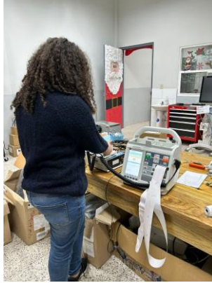
Ilustración 37: Pruebas de funcionamiento de desfibrilador
