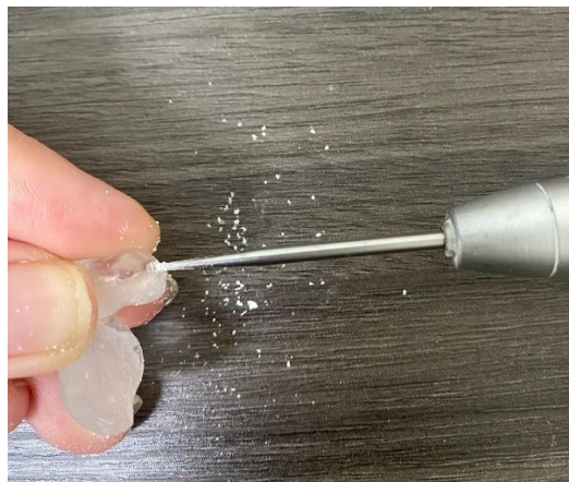
Ilustración 24. Perforación del conducto principal.
