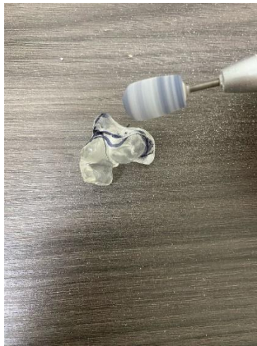
Ilustración 29. Proceso de fresado del molde
