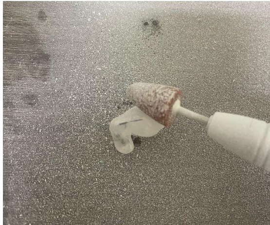
Ilustración 23. Fresado del molde.
