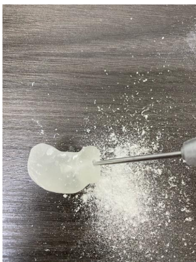
Ilustración 30. Perforación del conducto principal.
