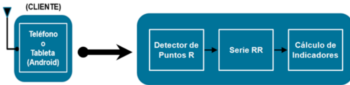
Figura 4.24 Secuencia en la que se realizan las operaciones de procesamiento digital en el cliente. (Smith, Cobo Alea, & Vázquez Seisdedos, 2020)
