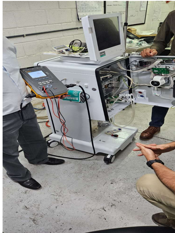
Ilustración 36.- Pruebas de Seguridad Eléctrica (Hemodiálisis)
