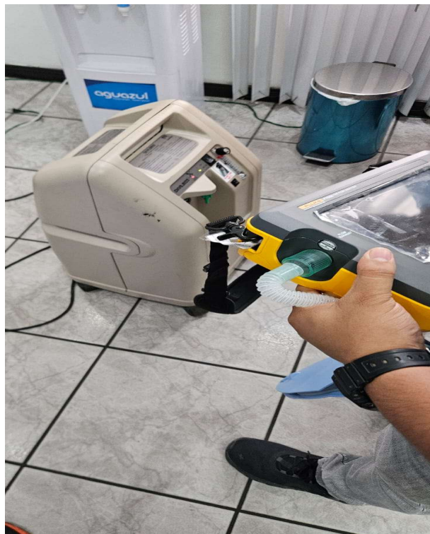
Ilustración 60.- Pruebas de Funcionamiento con Analizador FLUKE
