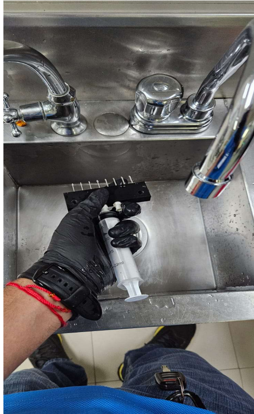
Ilustración 94.- Purgado de cepillo de Analizador ELISA (IHSS)
