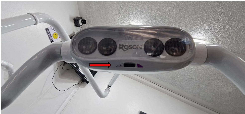
Ilustración 83.- Carcasa de plástico quebrada en fuente de iluminación
