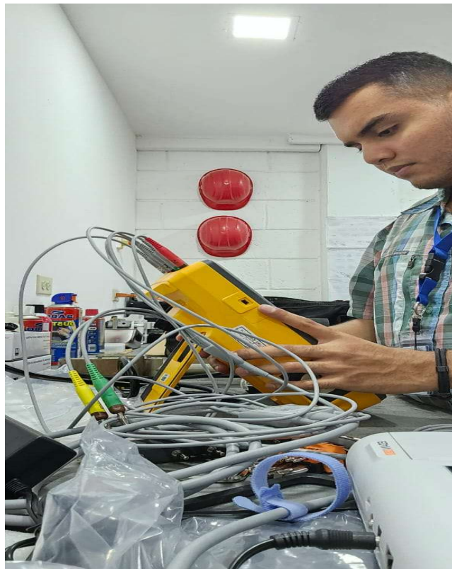
Ilustración 34.- Mantenimiento ECG con Analizador
