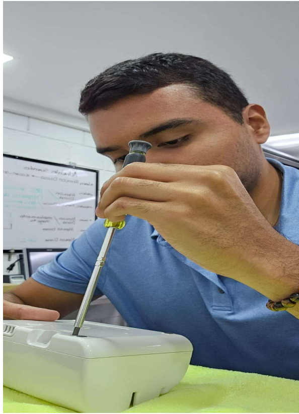
Ilustración 19.- Mantenimiento Correctivo Nebulizador
