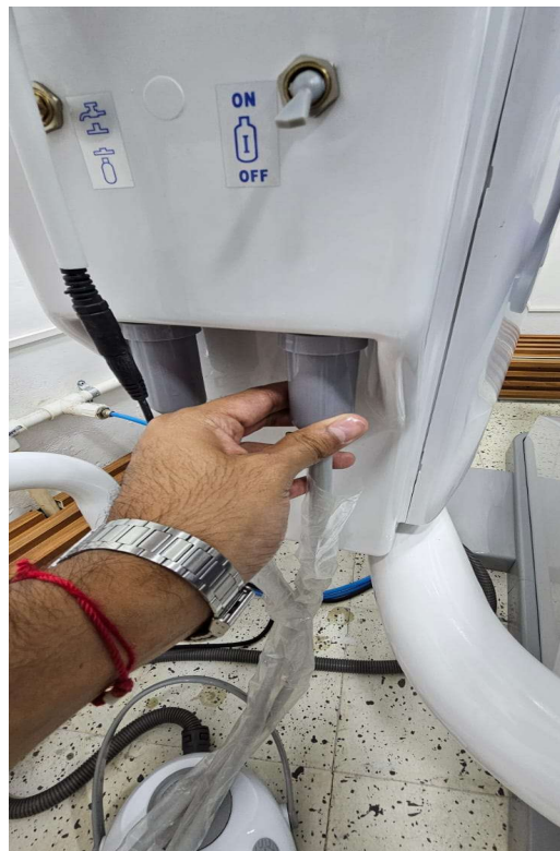
Ilustración 81.- Limpieza de filtros
