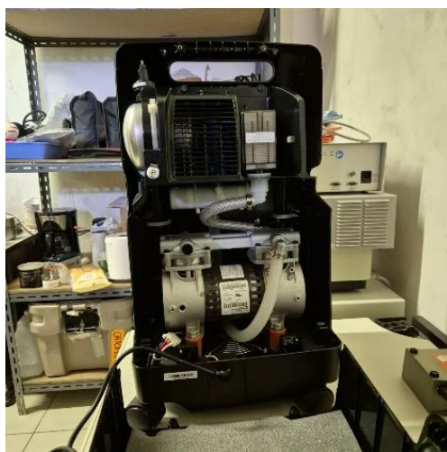
Ilustración 27: Mecanismo Interno de Concentrador de Oxígeno
