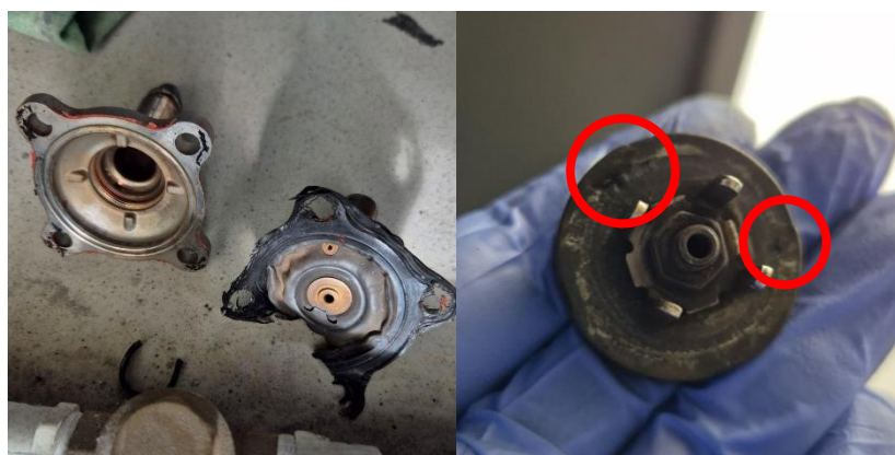
Ilustración 31: Empaque (derecha) y Cojín (izquierda) de Válvula Solenoide
