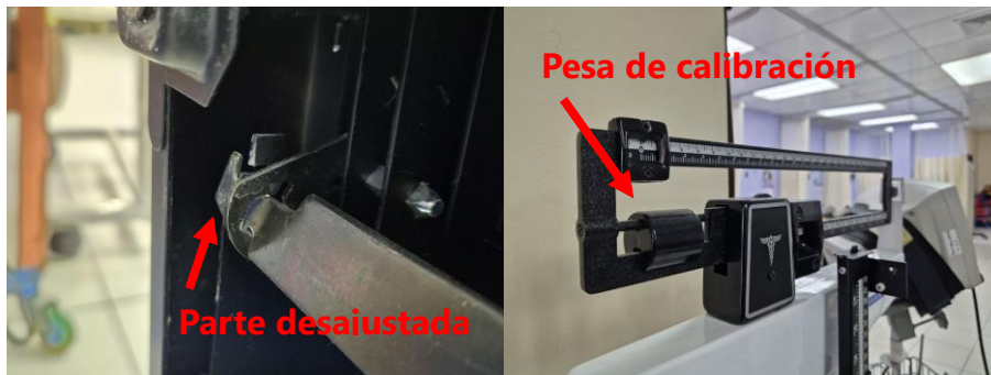
Ilustración 54: Calibración de Balanza con Tallímetro
