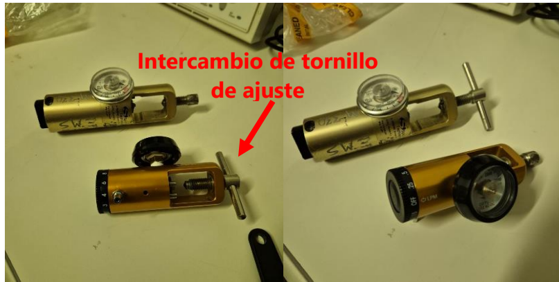
Ilustración 42: Tornillo de Ajuste en Regulador de Presión
