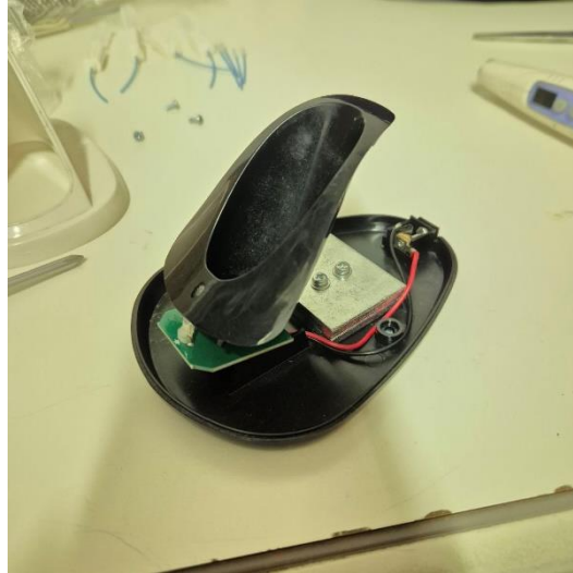
Ilustración 63: Circuito de Lámpara de Fotocurado
