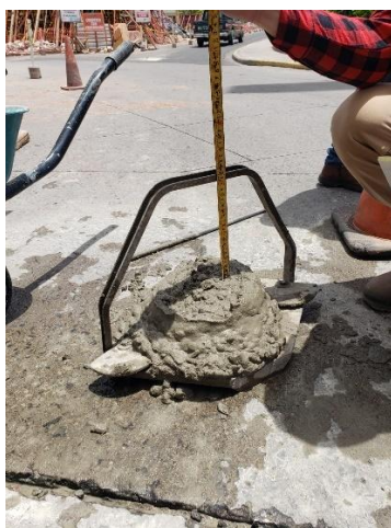
Ilustración 23. Revenimiento concreto bombeado
