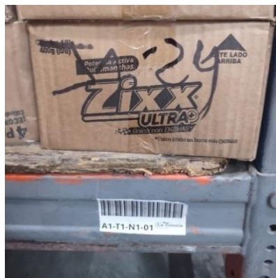
Figura 24. Demostración de etiqueta colocada en el rack
