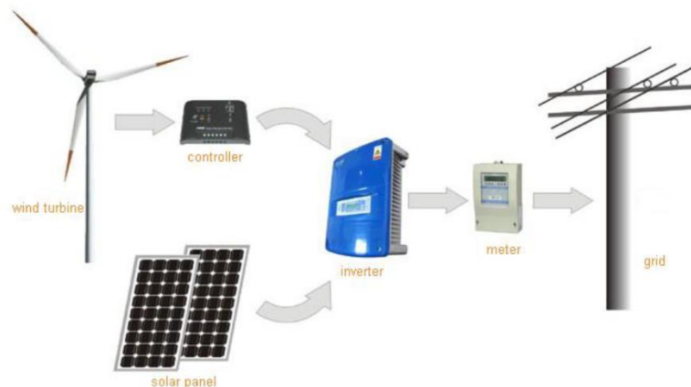
Figura 32 Esquema conceptual del grupo de generación híbrido eólico – solar
