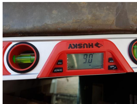
Figura 35 Imagen de Panel solar Poli cristalino 300 w, Medición de ángulo de Losa para montaje de panes
