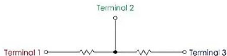
Figura 4. 11: Composición de un potenciómetro.
