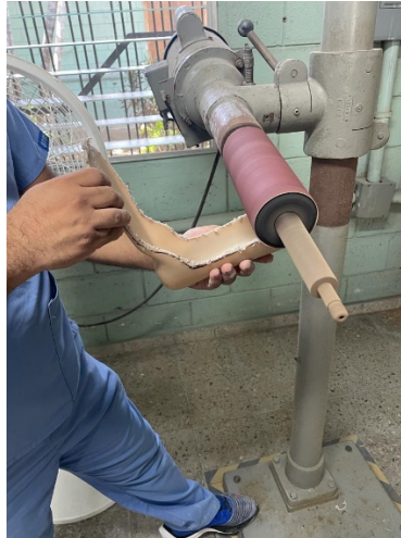
Ilustración 29 - Pulido de la pieza del método tradicional
