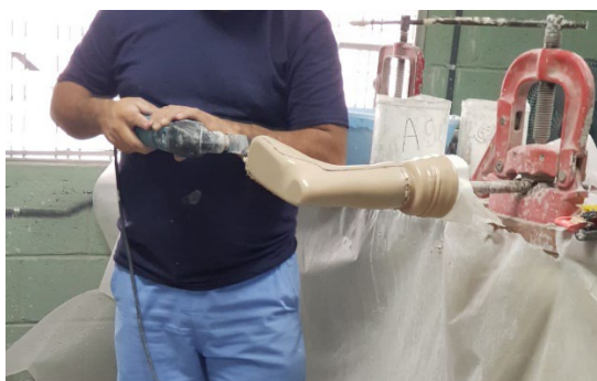
Ilustración 28 - Corte de molde plastificado del método tradicional
