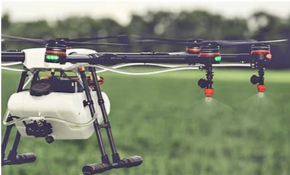
Figura 16- Dron equipado con químico para fumigación
