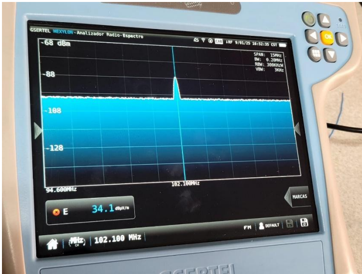
Figura 4-23: Verificación de frecuencia de salida.
