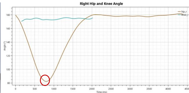
Figura 13. Gráfica de ángulos de las articulaciones de la cadera y rodilla en la elevación activa de la pierna.
