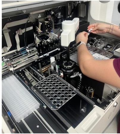
Ilustración 29. Cambio de bomba a Maglumi.
