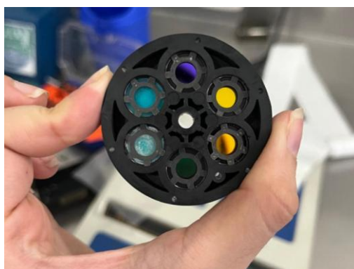
Ilustración 72. Filtro dañado StatFax.
