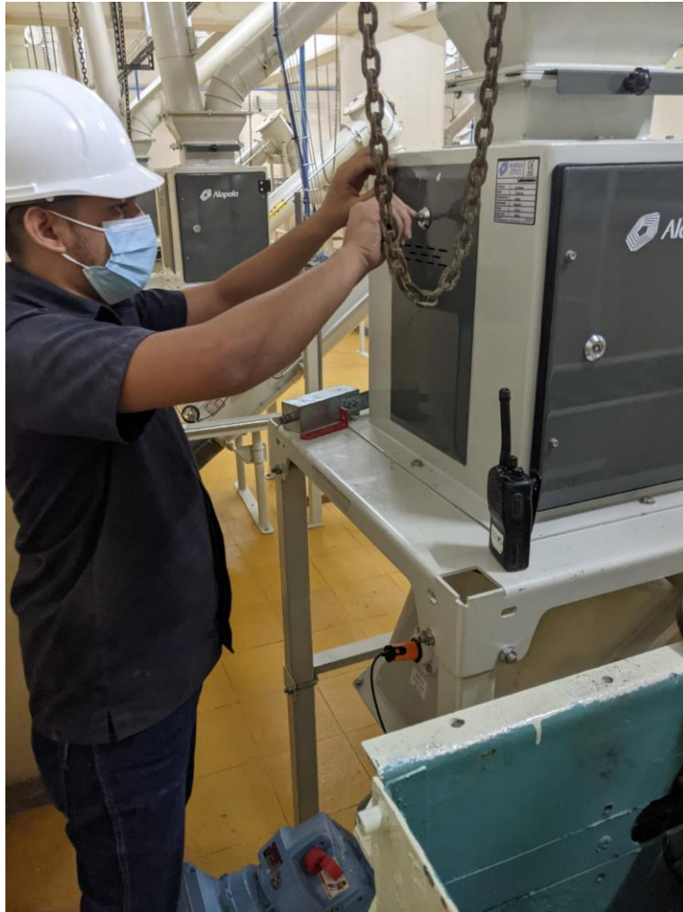
Ilustración 10 Operario realizando calibración con masa de 3kg
