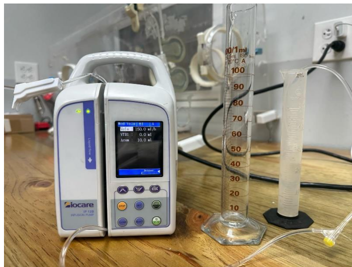
Ilustración 30 - Revisión y calibración de bombas de infusión.
