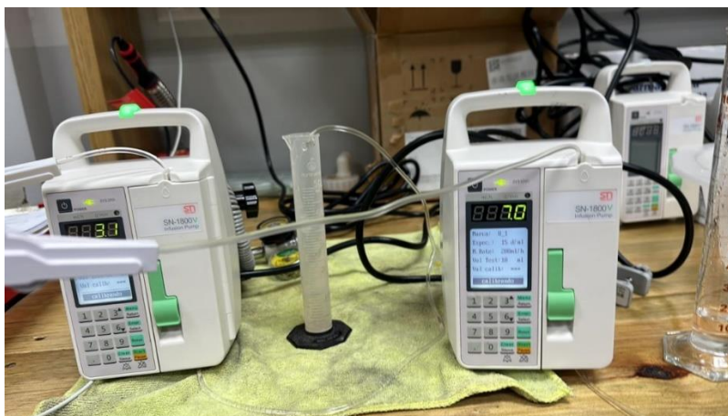
Ilustración 46 – Calibración de bombas de infusión.
