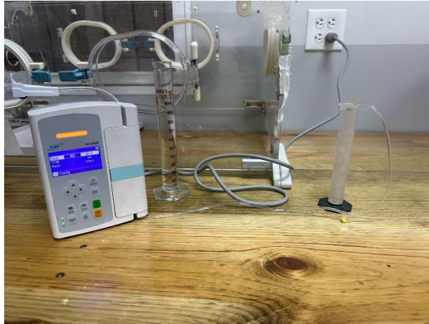
Ilustración 39 - Calibración de bombas de infusión.
