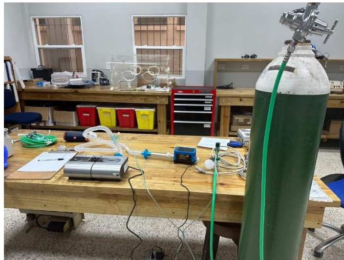
Ilustración 25 - Calibración de analizador.
