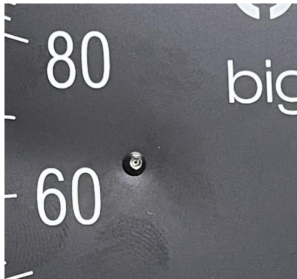
Ilustración 61: Tornillo averiado en esfigmomanómetro
