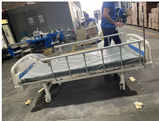
Ilustración 17: Armado y verificación de funcionamiento para cama hospitalaria sencilla
