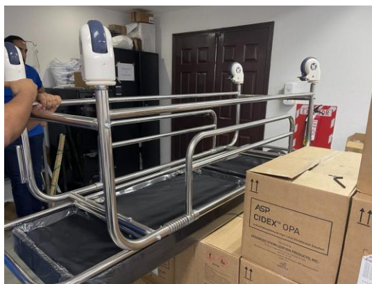
Ilustración 66: Ajuste de llantas en una cama de transporte utilizando un rach
