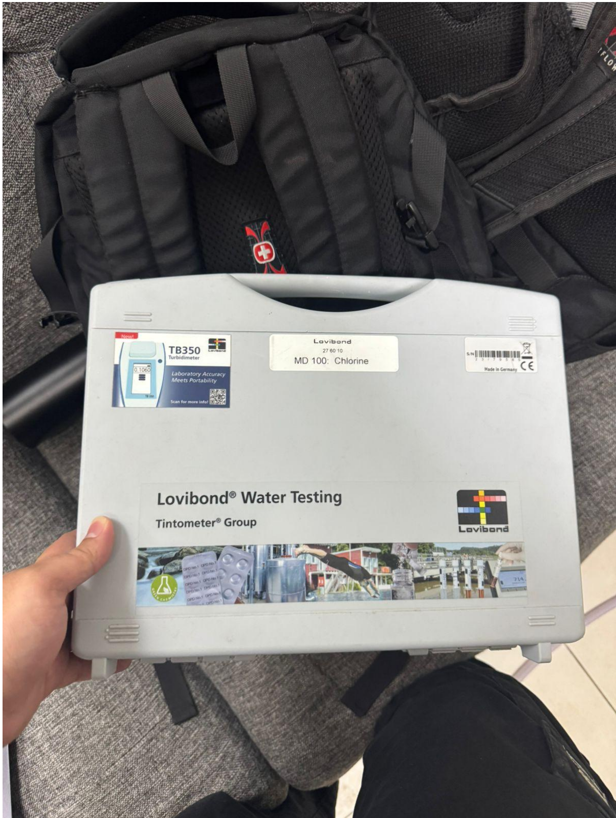
Anexo 8: Set para la medición de niveles de cloro en el agua tratada
