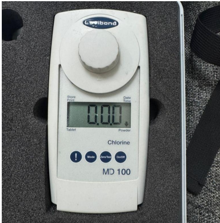
Ilustración 33: Medición de cloro en el fotómetro Lovibond MD 100
