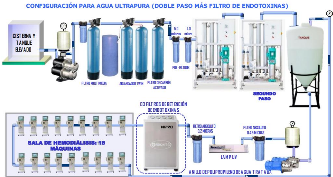
Anexo 1: Diagrama referencial planta tratamiento de agua
