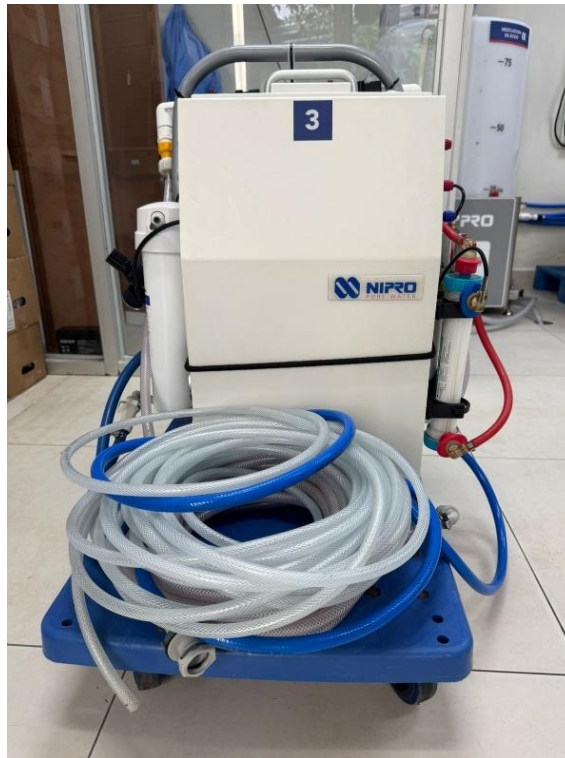
Ilustración 11: Osmosis inversa portátil NIPRO ROSI
