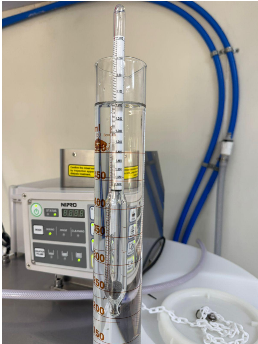
Ilustración 37: Medición de densidad en el ácido preparado
