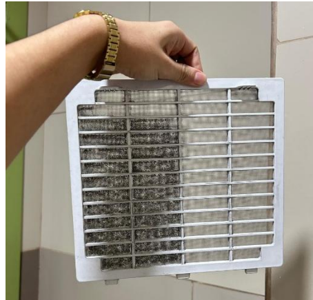
Ilustración 23. Filtro de deshumidificador
