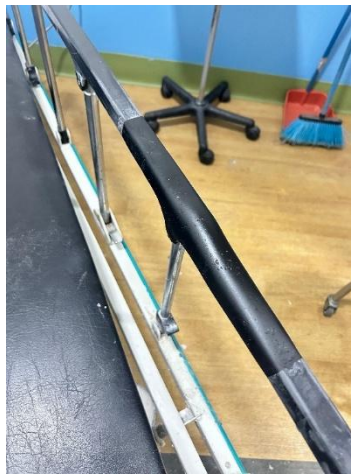
Ilustración 10. Una de las barandas de la camilla reparada
