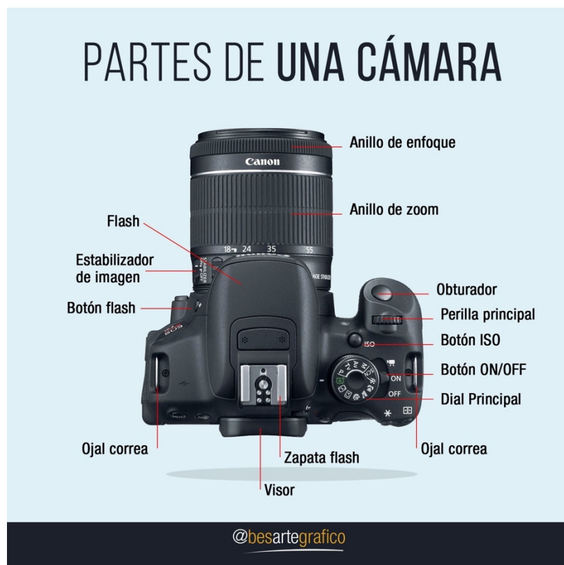
Ilustración 28. Partes de una cámara
